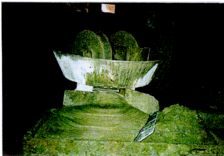
Figura III-19 Exemplo, de produção de argamassa com material reciclado em Buenos Aires.
