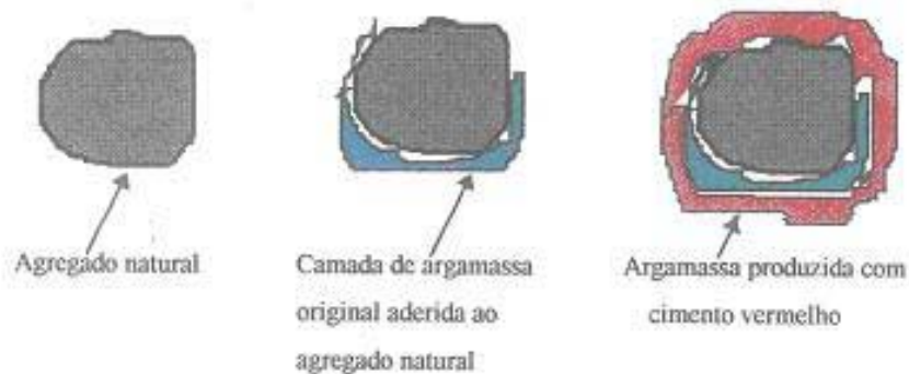
Figura II-9 Representação da argamassa aderida ao agregado existente no concreto produzido com agregado reciclado
