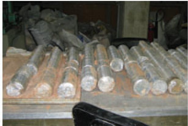
Figura 10. Extração de testemunhos cilíndricos de concreto da estrutura para avaliação da resistência potencial equivalente do concreto à compressão.
