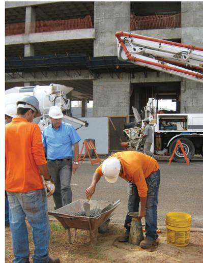
Figura 9. Ensaio para avaliação da consistência do concreto fresco através do ensaio de abatimento do tronco de cone *ABNT NBR NM 67:1998*
