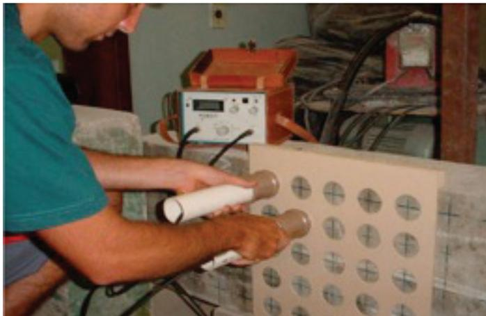
Figura 11. Ensaios não destrutivos para inspecionar a estrutura – ultrassom (Fonte: Lorenzi et al., 2012).
