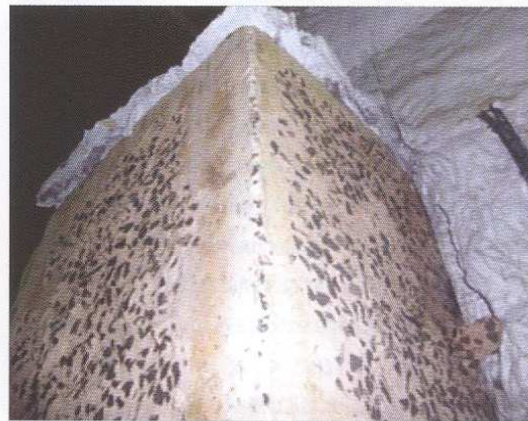
Figura 7 – Detalhe da profundidade do deslocamento, da pouca armadura exposta e das arestas “intactas” do pilar protótipo posterior ao evento de simulação de incêndio
