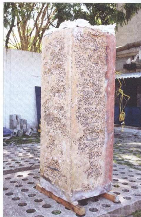
Figura 6 – Integridade do pilar protótipo e detalhe da seção transversal mantida após 180min (3h) de simulação de incêndio
