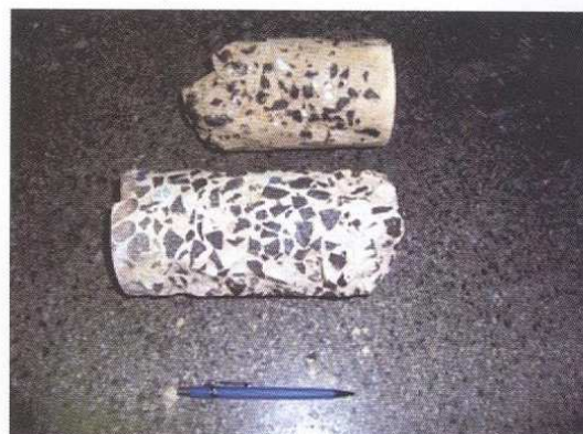
Figura 12 – Corpos de prova cilíndricos não armados com 100mm x 200mm desintegrados após o ensaio de simulação de incêndio, ensaiados em conjunto com o pilar protótipo
