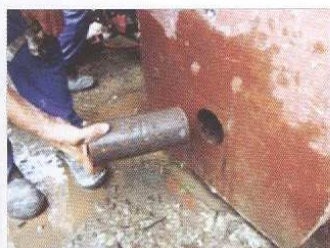
Figura 2 – Indicação do corte na base do protótipo, extração do testemunho e detalhe da amostra remanescente após o corte
