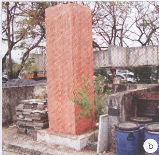
Figura 1 – (a) Edifício e-Tower, 162m de altura; e (b) réplica protótipo do pilar de concreto colorido de alta resistência, HSCC moldado na parte externa do laboratório da Universidade de São Paulo, São Paulo, Brasil
