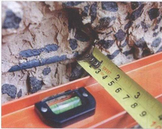
Figura 7 – Detalhe da profundidade do deslocamento, da pouca armadura exposta e das arestas “intactas” do pilar protótipo posterior ao evento de simulação de incêndio
