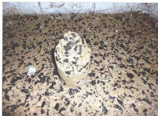
Figura 12 – Corpos de prova cilíndricos não armados com 100mm x 200mm desintegrados após o ensaio de simulação de incêndio, ensaiados em conjunto com o pilar protótipo
