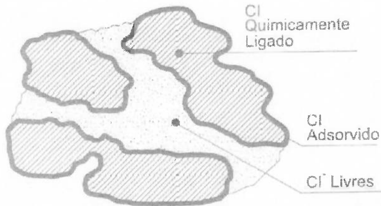
Figura 2.7: Formas de ocorrência de íons cloreto na estrutura do gel cimentício do concreto (CASCUDO, 1997).
