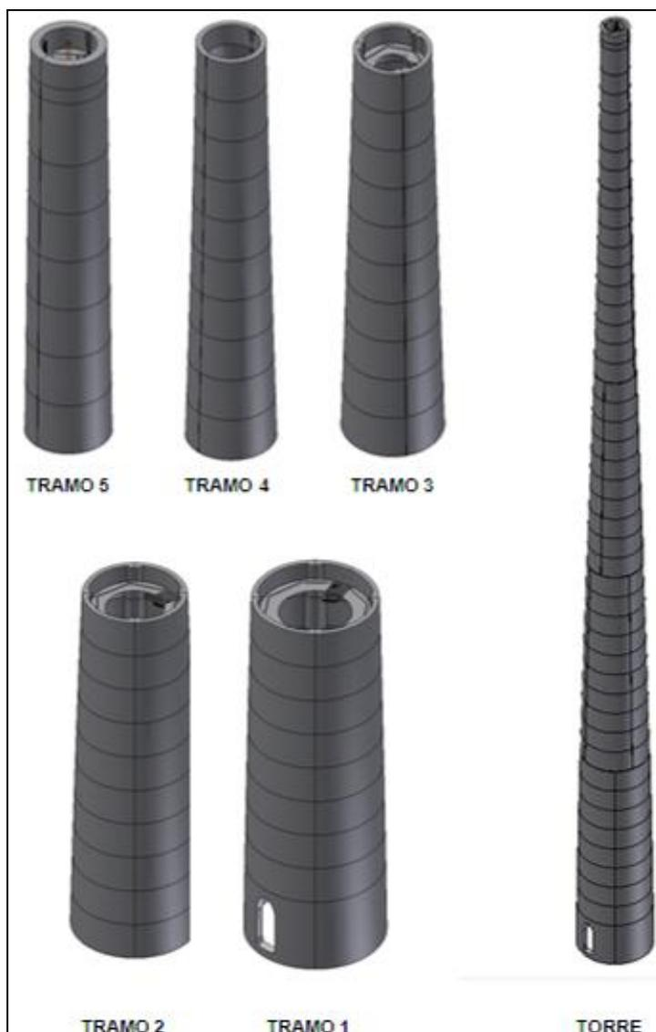
Figura 10. Esquema de composição da torre
