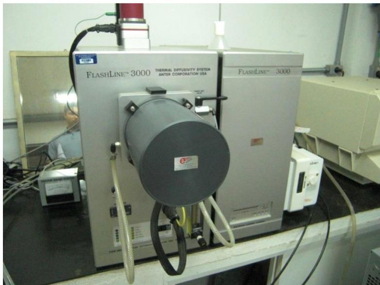
Figura 3 - Equipamento Thermal Diffusivity System modelo FlashLine™ 3000
