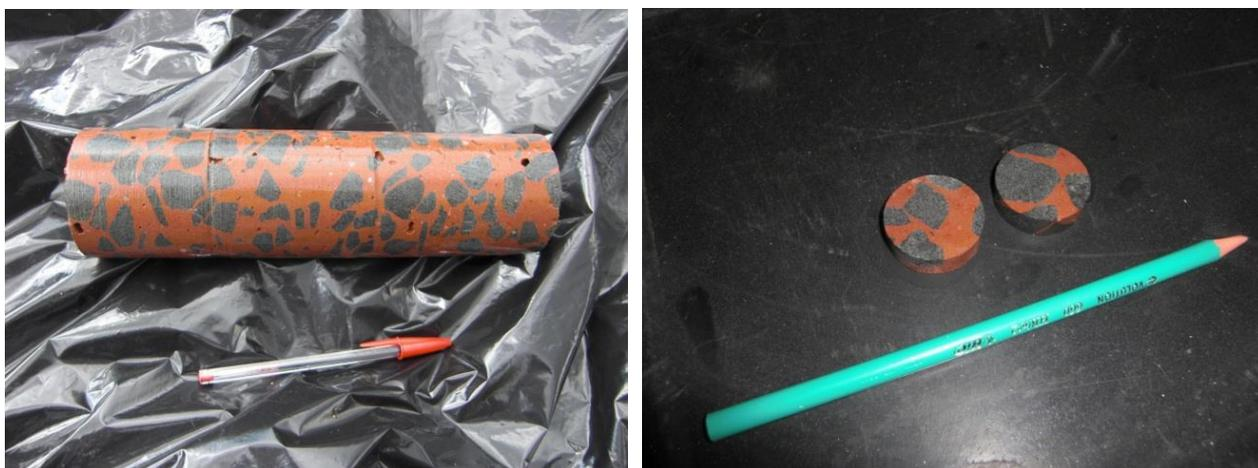
Figura 4 - Detalhe do testemunho extraído e das pastilhas de concreto produzidas para caracterização das propriedades térmicas
