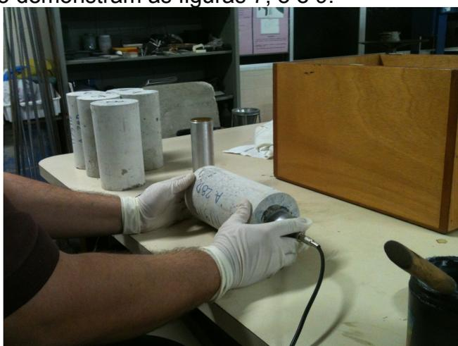
Figura 6 - Leitura do tempo de propagação da onda nos corpos de prova em estudo
