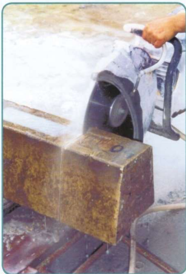
Figura 02 - Detalhe do corte dos dormentes
