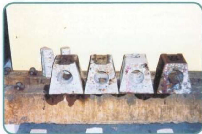
Figura 04 - Visão de 4 prismas com os cp's já extraídos
