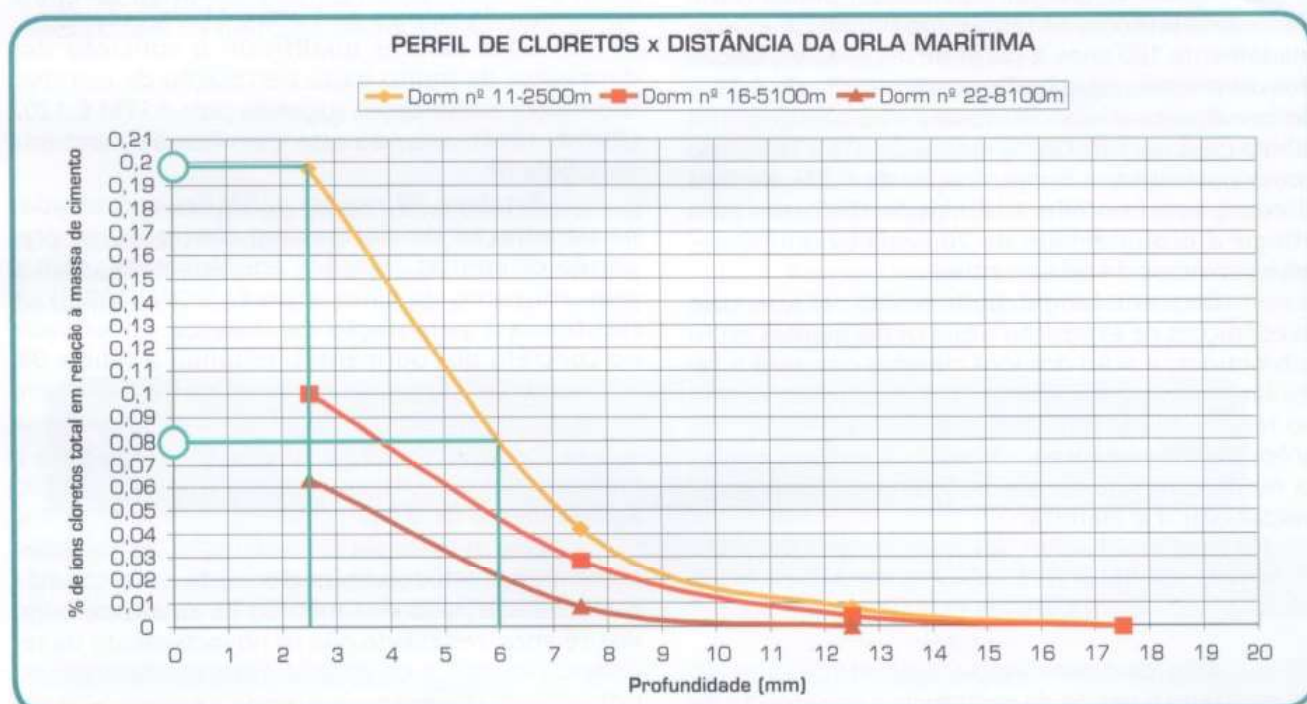
Figura 12 – Perfil de cloretos totais nos dormentes em função da distância da orla marítima
