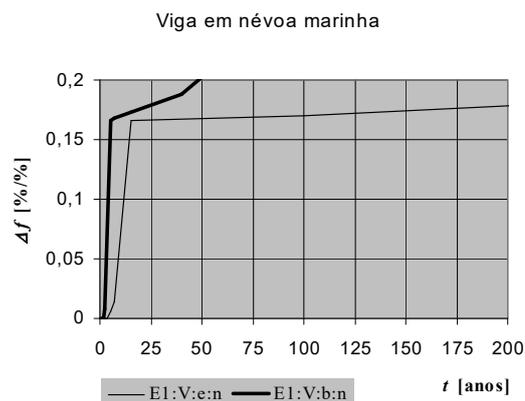
Figura H. 11. Deterioração da resistência à tração com a corrosão. E1:V:e:n; E1:V:b:n – Estrutura da etapa 1, viga em zona de névoa marinha, armaduras de aço carbono do estribo (e) e da barra longitudinal. As armaduras de aço inoxidável não despavimam.
