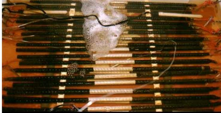
Figura 6. Estudo de barras em solução saturada de NaCl a 45<sup>0</sup>C, as barras de aço inoxidável colocadas na região não aerada (LAMARCA e TULA, 1998).
