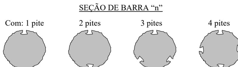
Figura G. 3. Corrosão por cloreto nas barras de aço carbono com ataque generalizado e destaque de pites na mesma seção.
