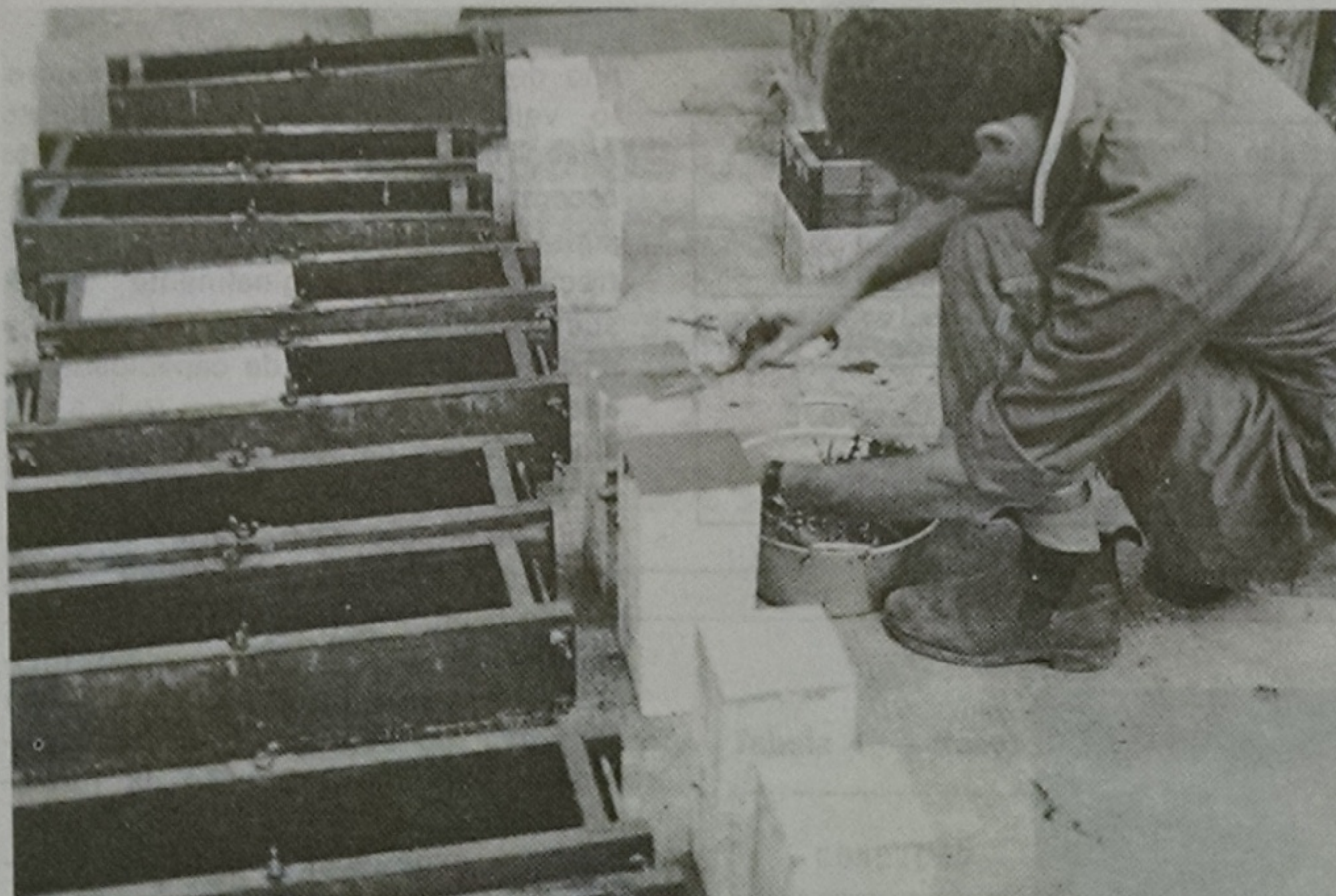
Foto 1 — Moldagem dos corpos de prova destinados ao ensaio de resistência à tração por flexão
