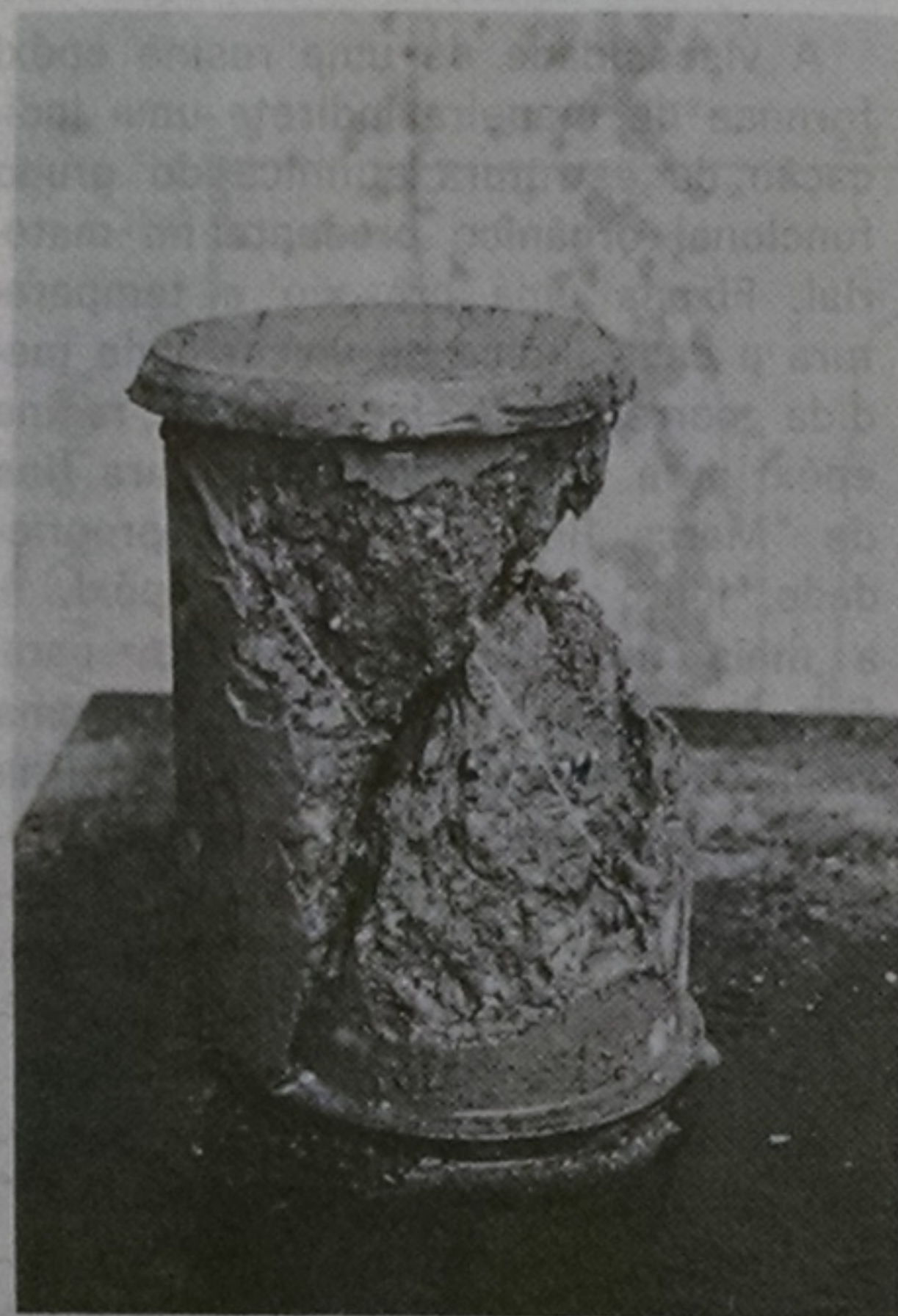
Foto 5 — Adesivo de boa qualidade. Ruptura normal do corpo de prova, fora da seção de colagem.
