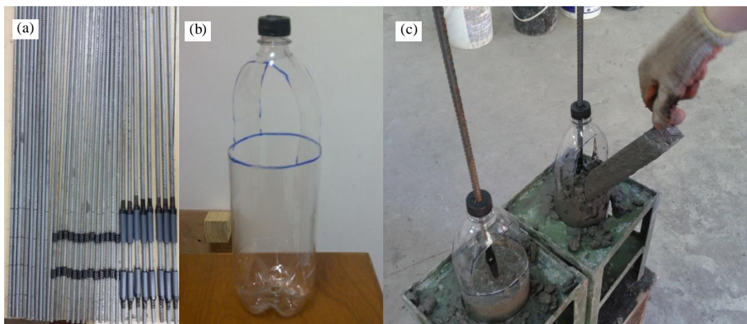
Figura 3.32 – (a) Colocação de separadores plásticos nas barras de aço (b) Garrafa PET. (c) Concretagem (FRUTOS, LOVERA; 2013)
