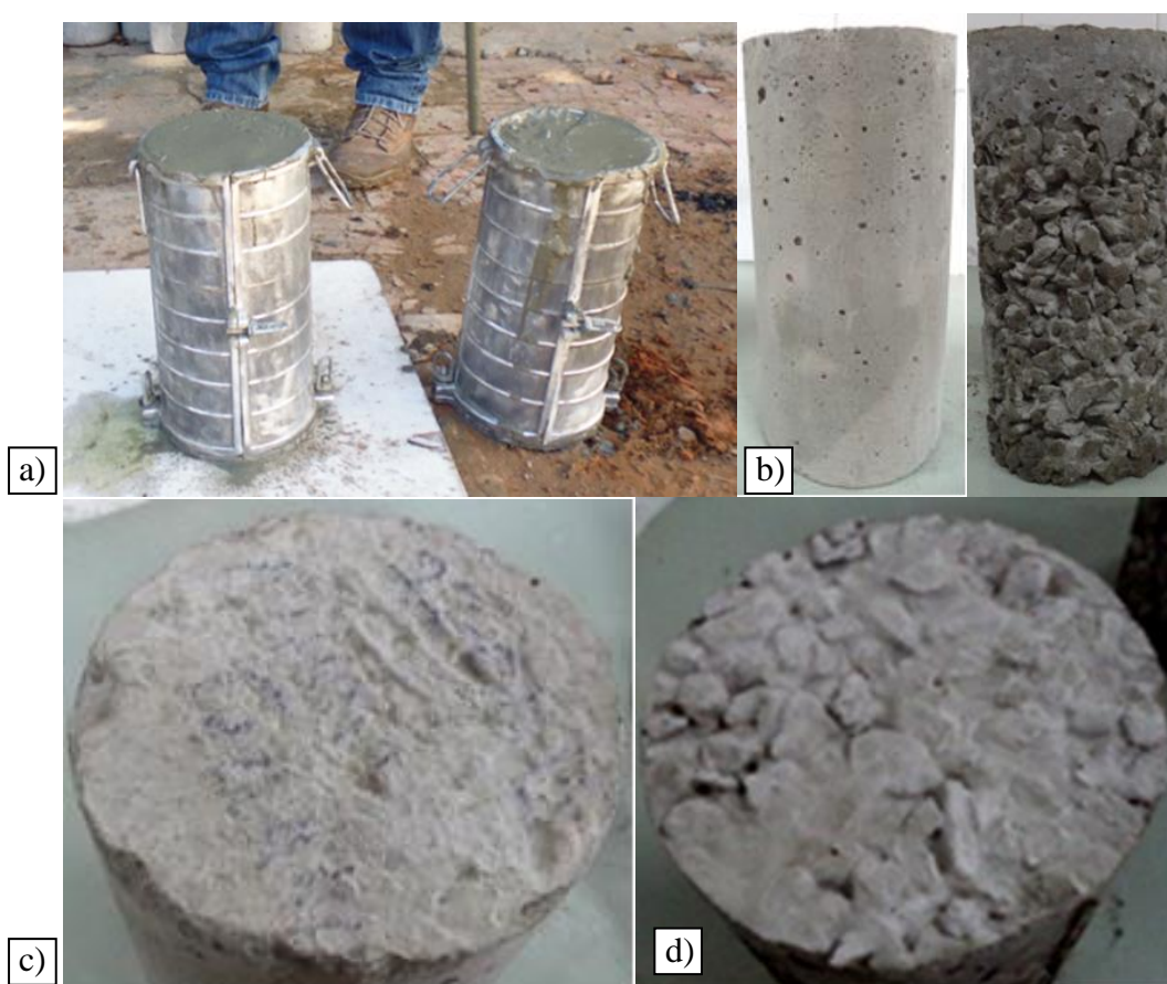
Figura 2.15 – Corpos de prova com: a) superfície plana e irregular, b) adensamento inadequado, c) e d) acabamento inadequado do topo
