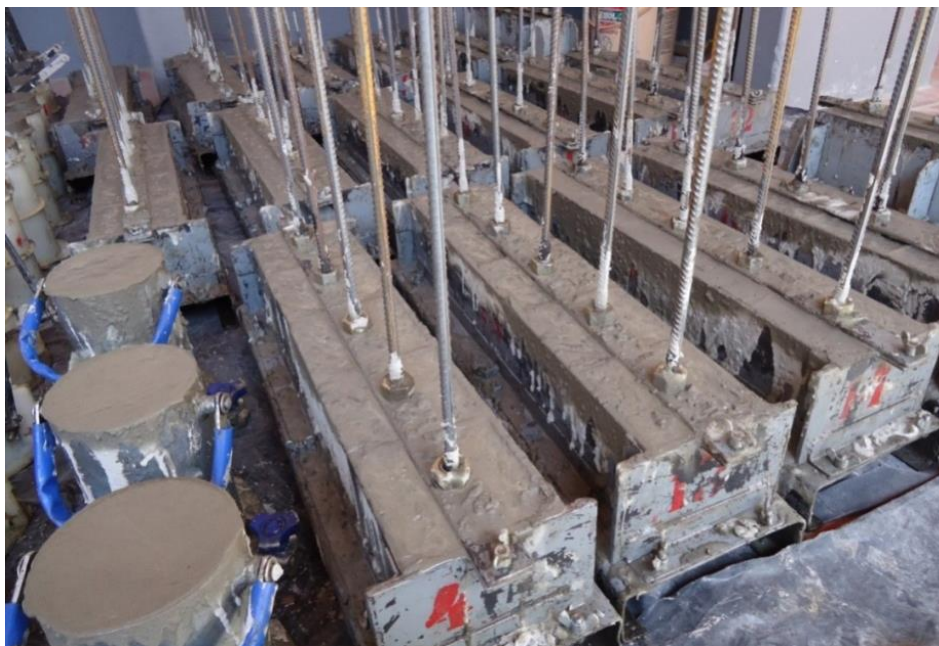
Figura 4.43 – Corpos de prova CAPULOT e CPs recém moldados
