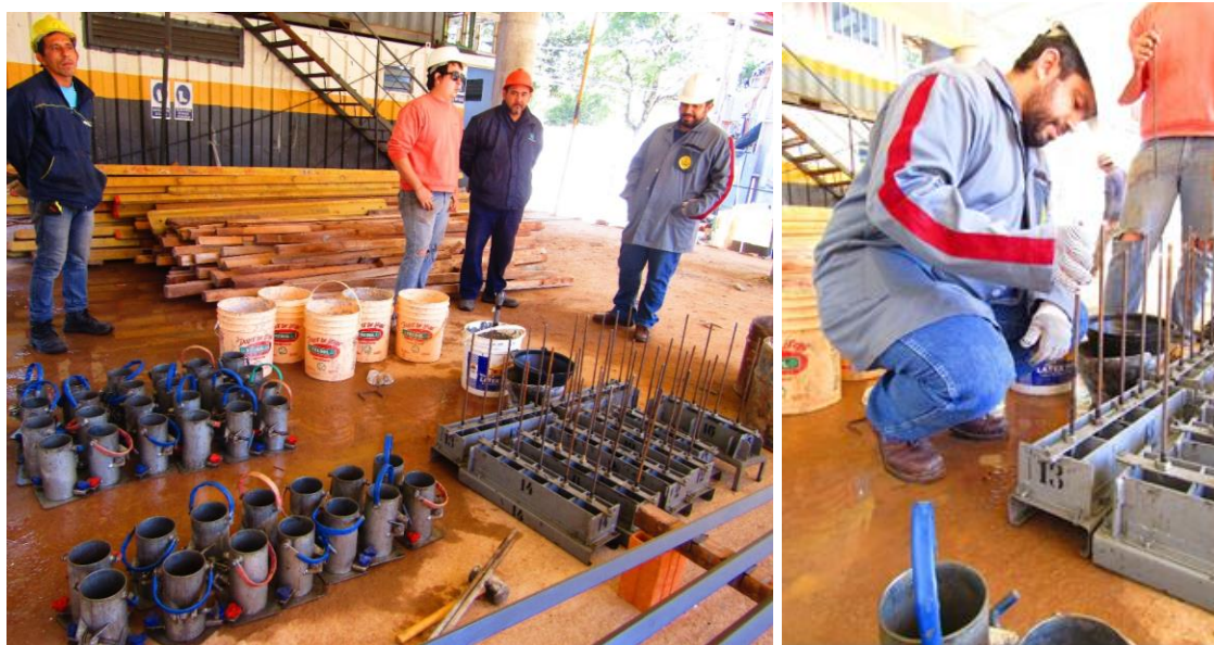
Figura 6.4 – Moldes preparados para moldagem
