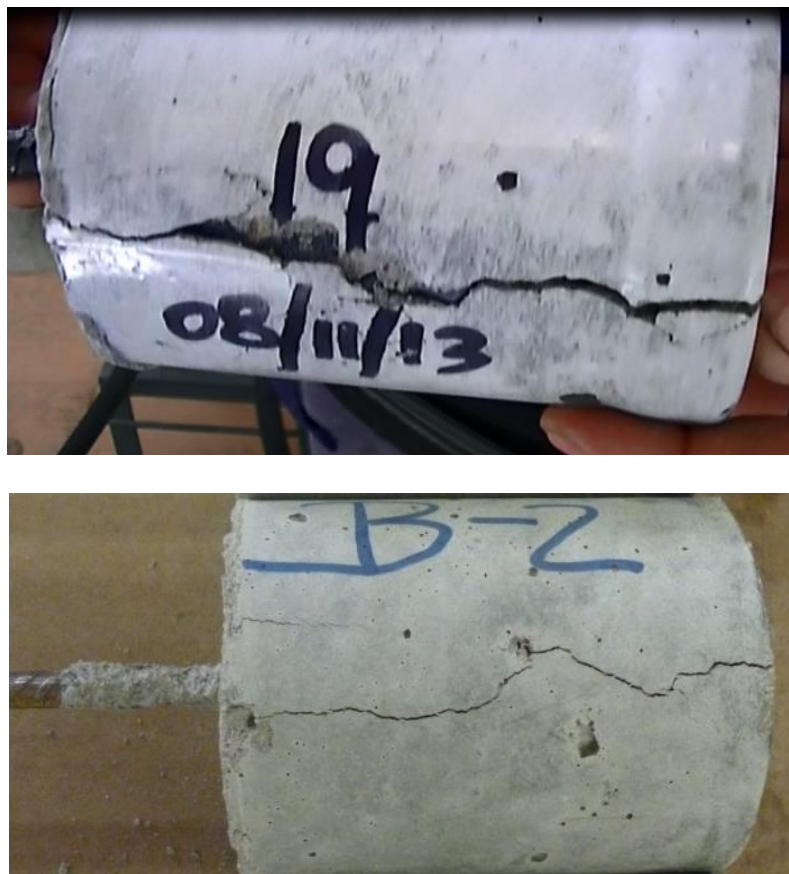
Figura 4.15 – Fendilhamento em dois corpos de prova APULOT
