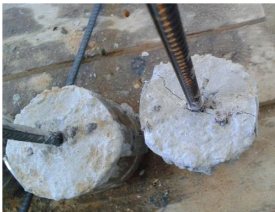
Figura 3.35 – Rupturas por deslizamento de barra de 8 mm, à esquerda, e fendilhamento para barra de 10 mm, à direita, com o mesmo concreto (CANDIA; LARÁN, 2014)
