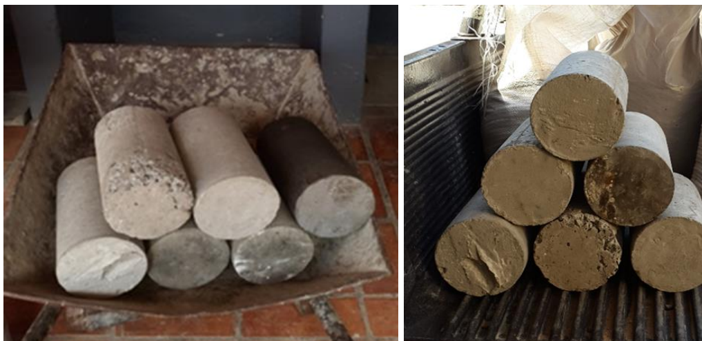
Figura 2.16 – Corpos de prova com manipulação deficiente para transporte ao laboratório de ensaio
