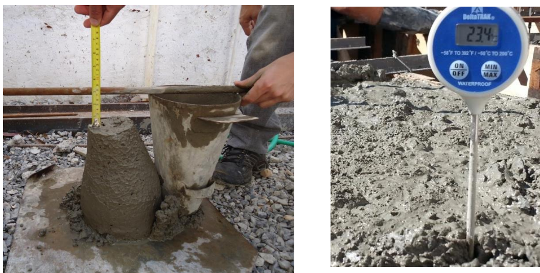
Figura 4.34 – Ensaio de consistência, conforme a NBR NM 67 (ABNT, 1998) e controle de temperatura, com leituras de, respectivamente, 70 mm e 23,4 °C
