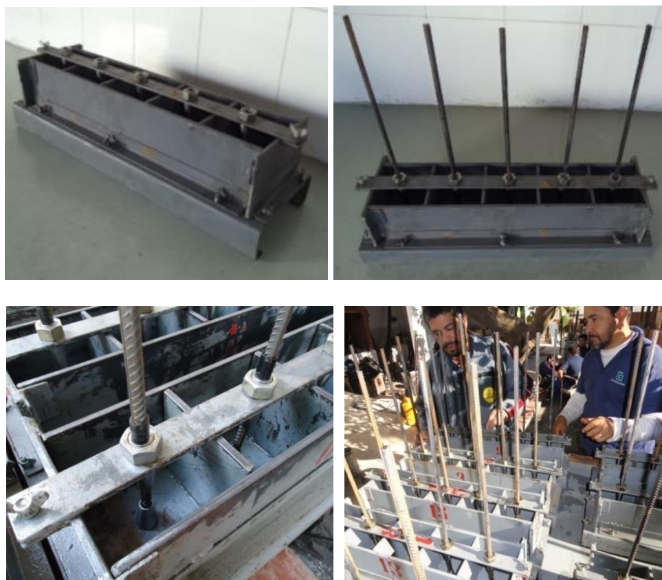
Figura 4.32 – Fixação das barras nos moldes CAPULOT
