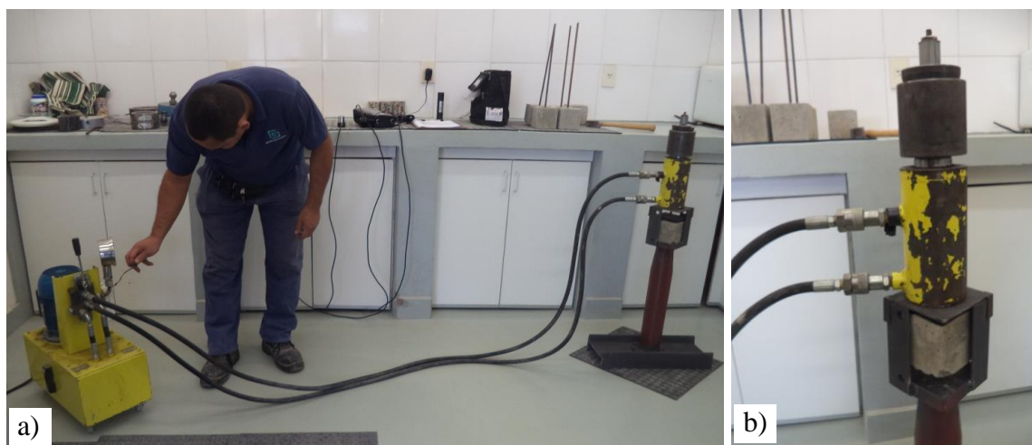
Figura 4.64 – a) Ensaio em corpo de prova CAPULOT. b) Detalhe dos discos de neoprene em ensaio em corpo de prova CAPULOT
