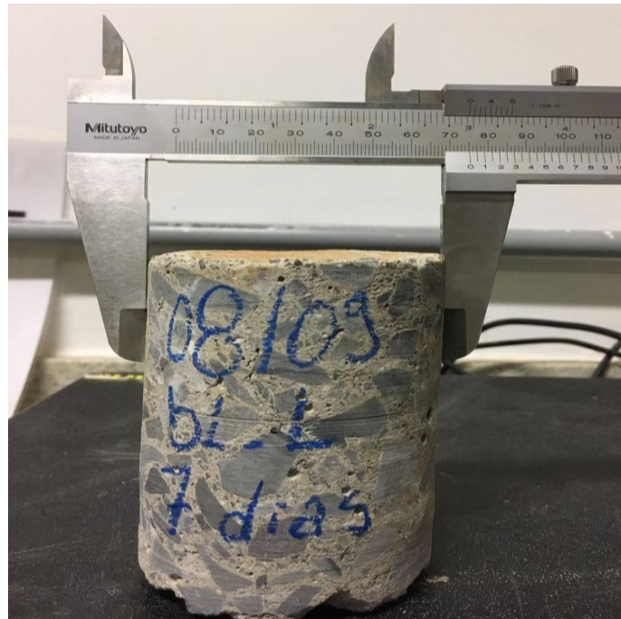
Figura 4.5: Imagem do testemunho extraído da laje. Fonte do (autor)
