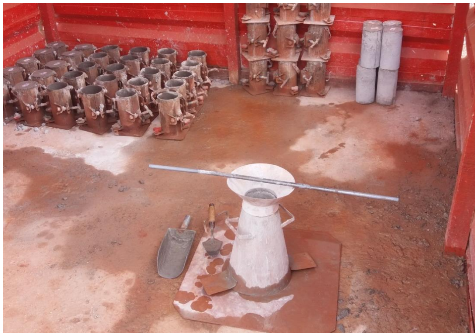
Figura 4.2: Instrumentos para controle de qualidade no canteiro de obras:
