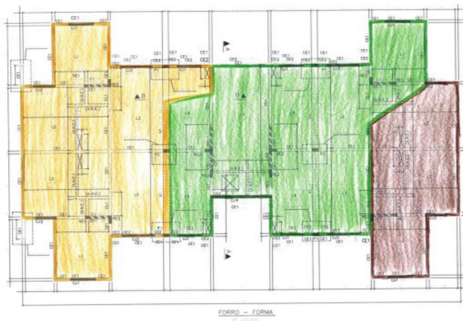
Figura 4.6: Rastreabilidade do concreto. Fonte: (do autor)
