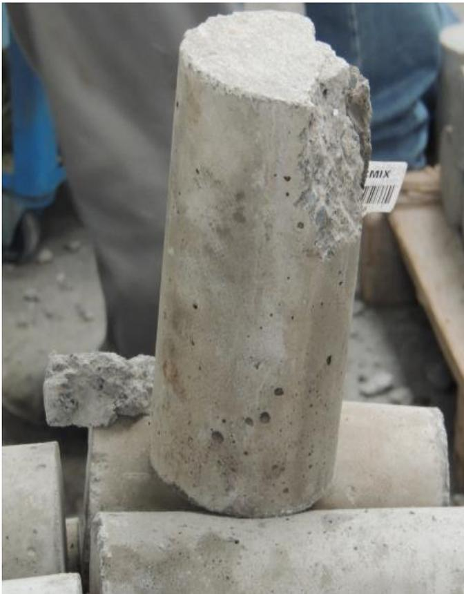
Figura 4. Ruptura no topo por erro de ensaio
