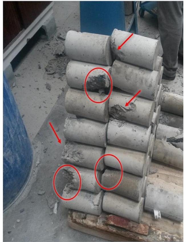
Figura 5. Ruptura no topo por erro de ensaio
