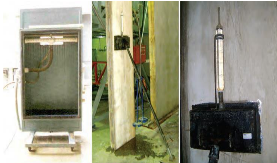
Fotografia 15 – Câmara para ensaio de estanqueidade
