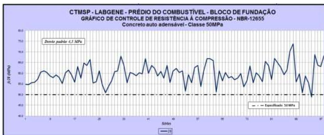
Figura 8. Resistência à compressão
