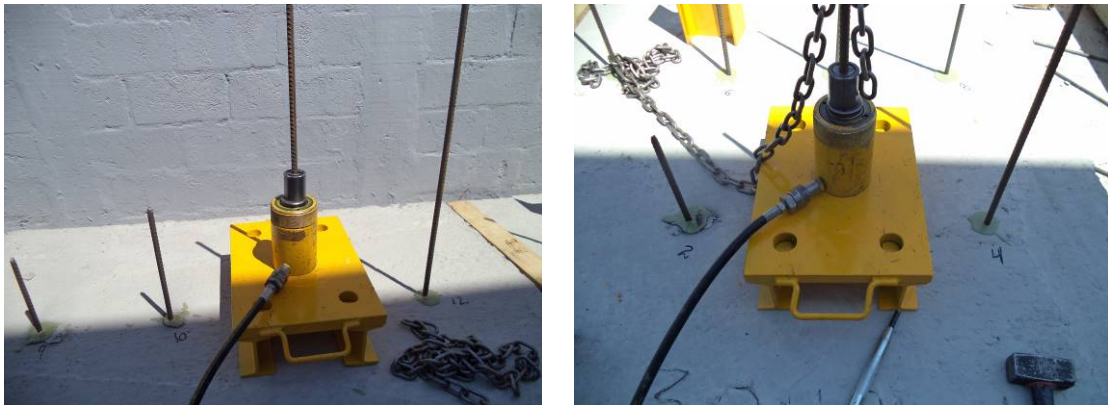
Figura 87 - Detalhe da realização do ensaio em substrato úmido disposto na posição horizontal Fonte: Autor
