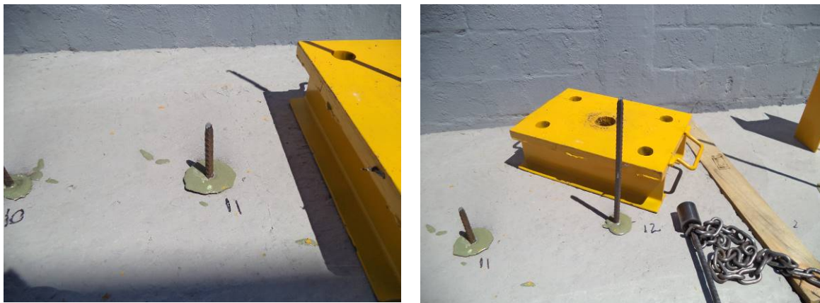
Figura 88 - Detalhe da ruptura do aço após realização do ensaio Fonte: Autor
