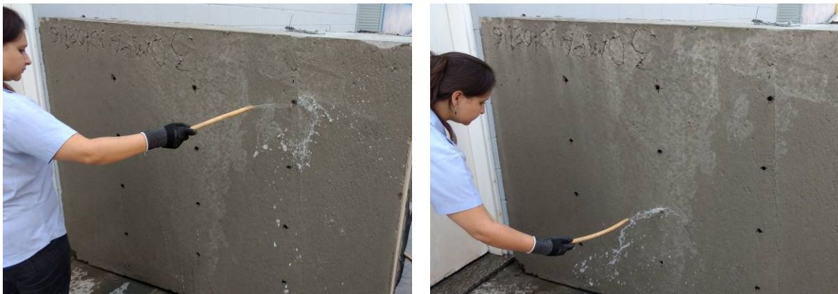
Figura 41 - Detalhe da saturação das placas dispostas na vertical
