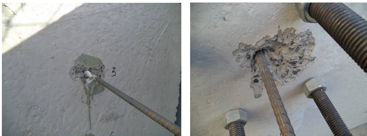
Figura 91 - Exemplos do método de falha por escorregamento encontrado
