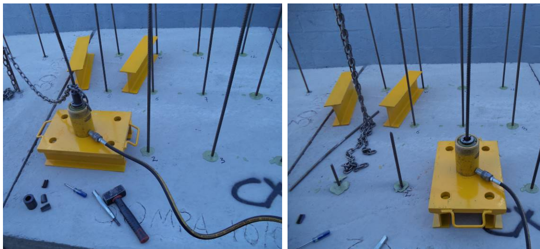
Figura 85 - Detalhe da realização do ensaio em substrato seco disposto na posição horizontal Fonte: Autor
