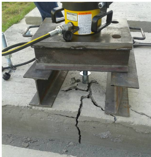
Figura 10 - Detalhe da falha por fissuração Fonte: Acervo Âncora (2016)
