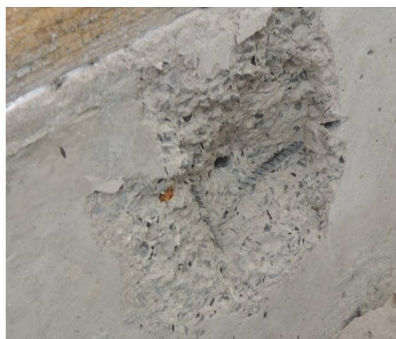
Figura 8 - Detalhe da falha por cone de concreto Fonte: Acervo Âncora (2016)
