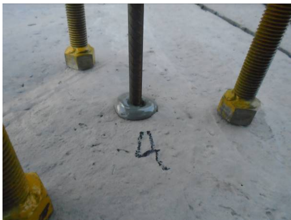
Figura 77 - Detalhe do vergalhão antes de ser submetido a tração e o método de falha pela ruptura do aço Fonte: Autor
