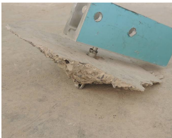
Figura 8 - Detalhe da falha por cone de concreto Fonte: Acervo Âncora (2016)
