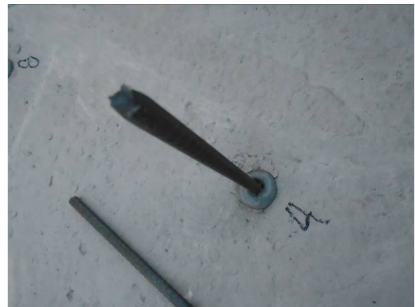
Figura 77 - Detalhe do vergalhão antes de ser submetido a tração e o método de falha pela ruptura do aço Fonte: Autor
