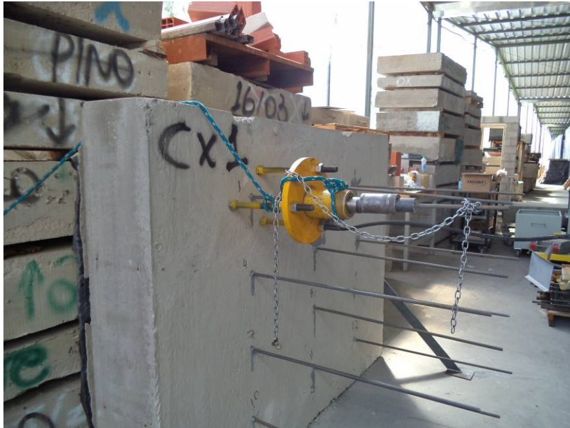
Figura 81 - Detalhe da realização de ensaio em substrato seco na posição vertical Fonte: Autor
