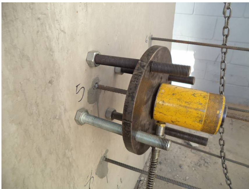
Figura 89- Detalhe da realização do ensaio em substrato seco disposto na posição vertical Fonte: Autor
