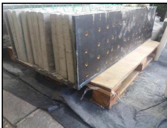
Figura 75- Forma de acondicionamento das placas durante o período de secagem.
