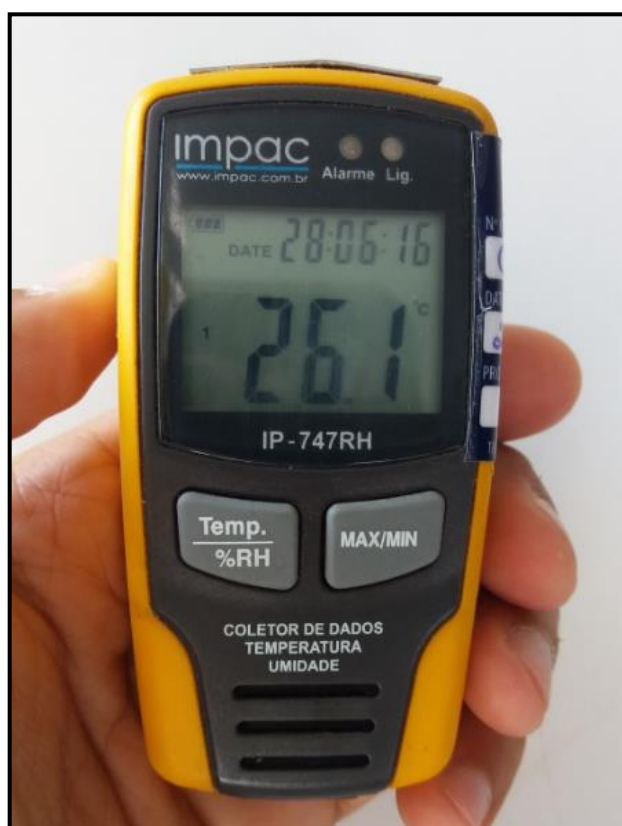
Figura 91-Detalhe do termohigrômetro utilizado no experimento.
