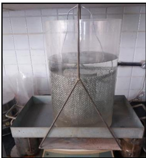
Figura 89- Pesagem após fervura em balança hidrostática.
