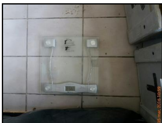
Figura 57-Balança utilizada na pesagem dos insumos do concreto.
