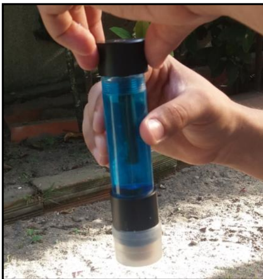
Figura 18-Exemplo do eletrodo de referência de cobre/sulfato de cobre.
