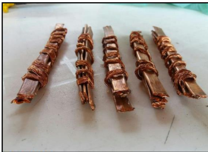
Figura 50-Detalhe da ligação do cobre com a armadura de aço.
