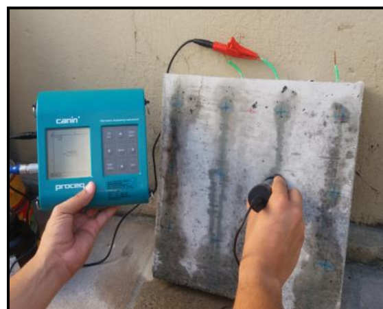
Figura 99-Execução do ensaio. 12 pontos por placa.
