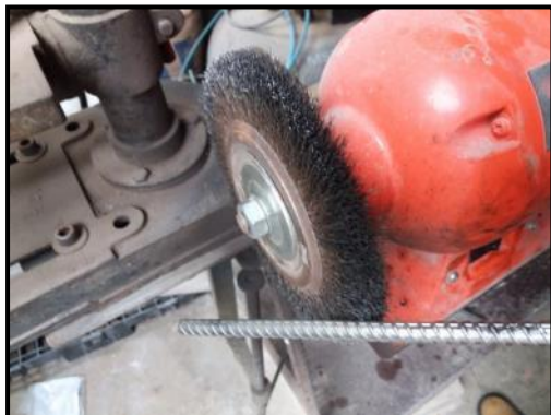
Figura 108-Utilização de lixadeira mecânica para retirar as incrustações mais aderidas.
