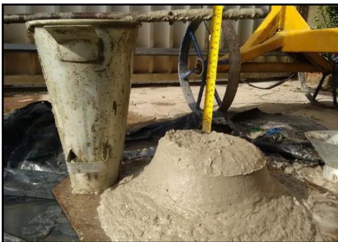
Figura 81-Verificação da consistência por meio do abatimento do tronco de cone.
