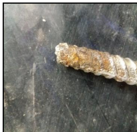
Figura 109-Aspecto final da barra, pronta para ser pesada.
