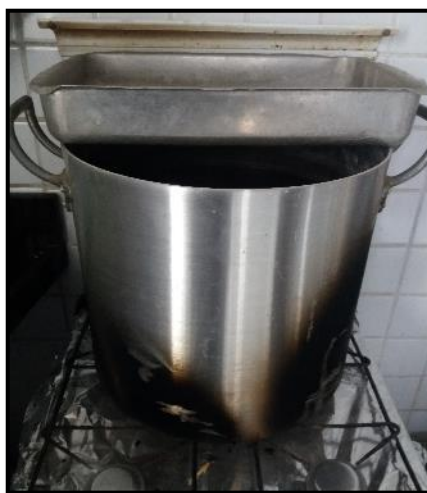
Figura 88-Colocação dos corpos de prova em fervura por 5 h.
