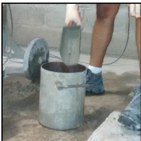
Figura 77-Colocação inicial do concreto dentro do cilindro.
