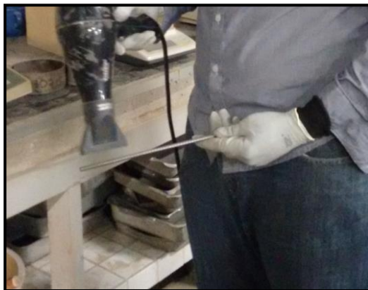
Figura 29-Secagem das barras após limpeza.
