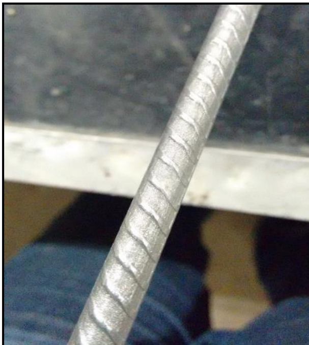
Figura 31-Detalhe do aspecto final das barras após limpeza e secagem.
