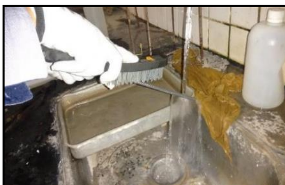
Figura 28-Limpeza das barras com água corrente e escova de aço.
