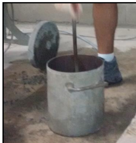
Figura 76- Adensamento com haste metálica.
