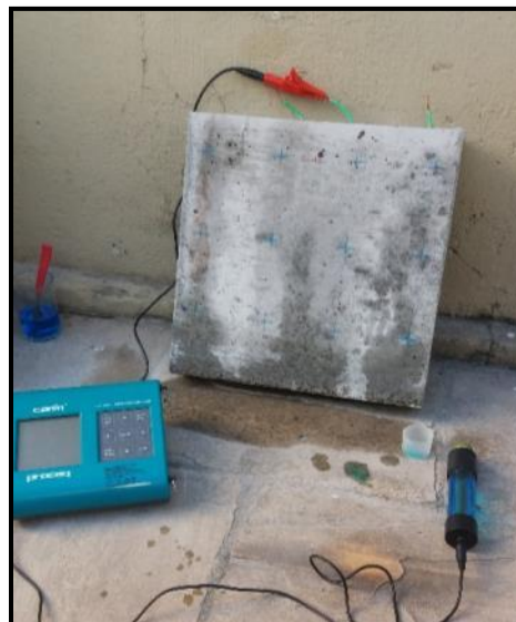
Figura 97-equipamento com eletrodo e ligação com o aço.
