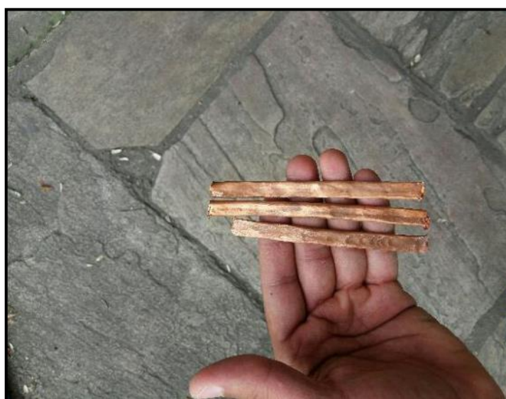
Figura 48-Tubo de cobre cortado e amassado diametralmente.
