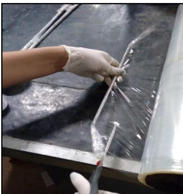
Figura 32-Proteção das barras com plástico filme.
