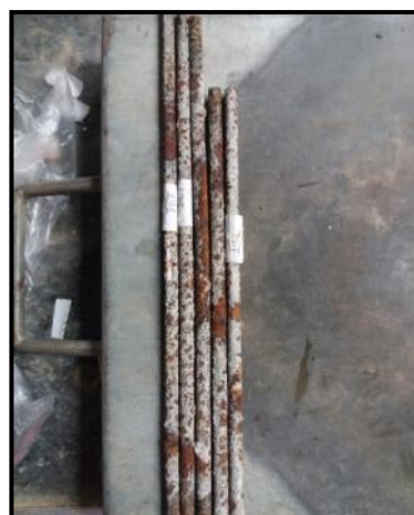
Figura 104-. Malha desfeita e barras prontas para a limpeza final e pesagem.
