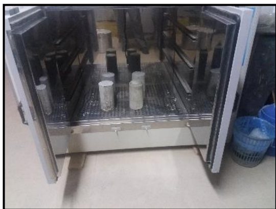
Figura 87-Imersão dos corpos de prova por 72 h.
