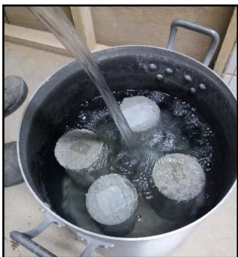
Figura 87-Imersão dos corpos de prova por 72 h.
