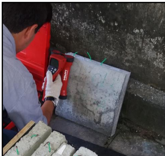
Figura 93-escaneamento da face A para medida do cobrimento.
