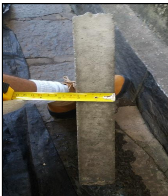
Figura 95-Medindo a espessura da placa. Uma medida em cada lado.
