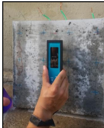
Figura 101-Medição da resistividade superficial.
