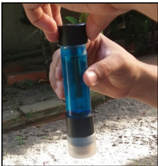
Figura 96-Eletrodo de cobre e sulfato de cobre.
