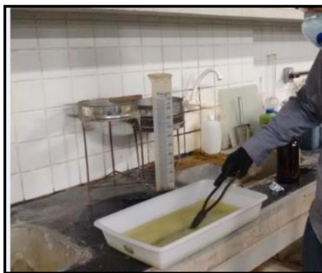
Figura 26-Colocação das barras dentro da solução ácida para limpeza.
