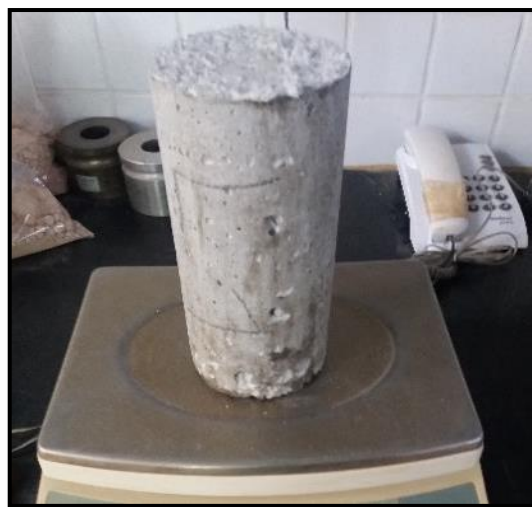
Figura 90- Secagem com pano e pesagem da massa específica saturada.
