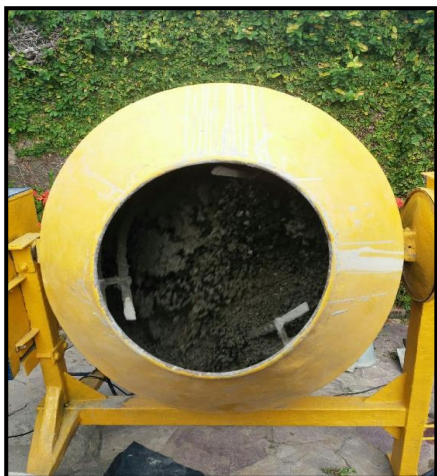
Figura 59- Betoneira de 400 litros utilizada na mistura do concreto.
