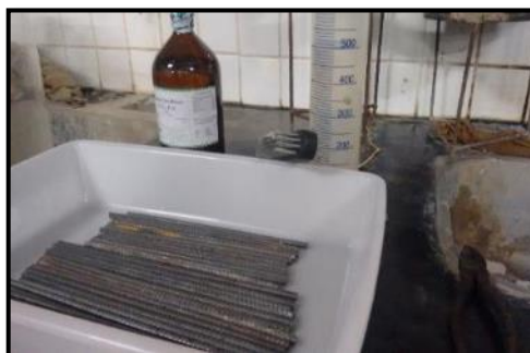
Figura 25-Colocação das barras dentro de recipiente plástico para limpeza.
