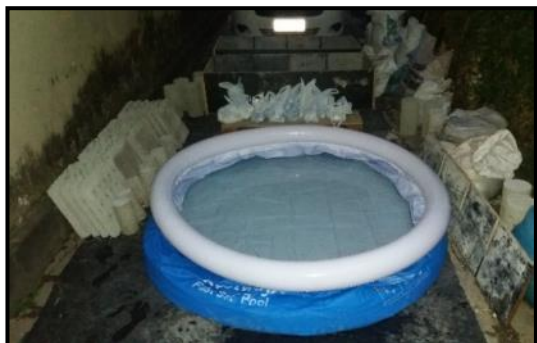
Figura 71-Visão geral da configuração da “piscina” para imersão das placas.
