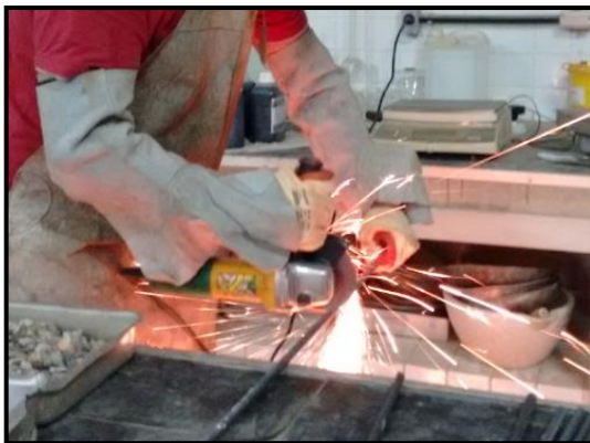
Figura 23-Realização do corte dos varões de aço com lixadeira e disco para aço.
