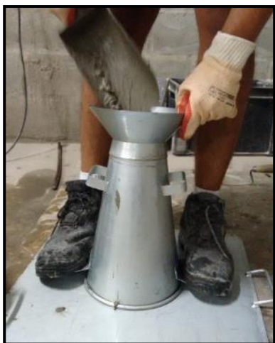
Figura 80-Preenchimento do tronco de cone com concreto.
