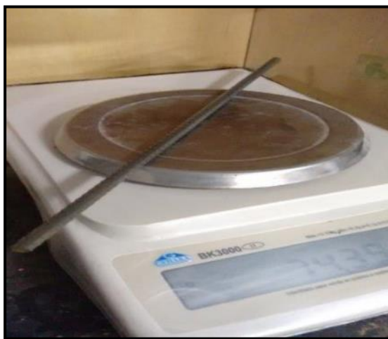
Figura 30-Detalhe da pesagem das barras antes do início do processo de corrosão.
