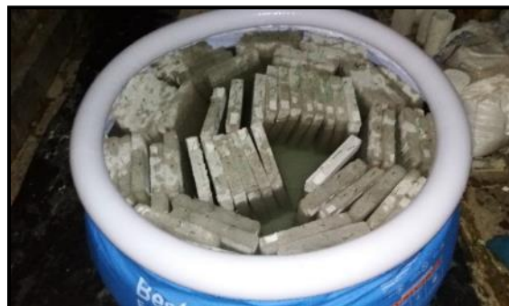
Figura 74- Visão geral das 72 placas dentro da água salgada.
