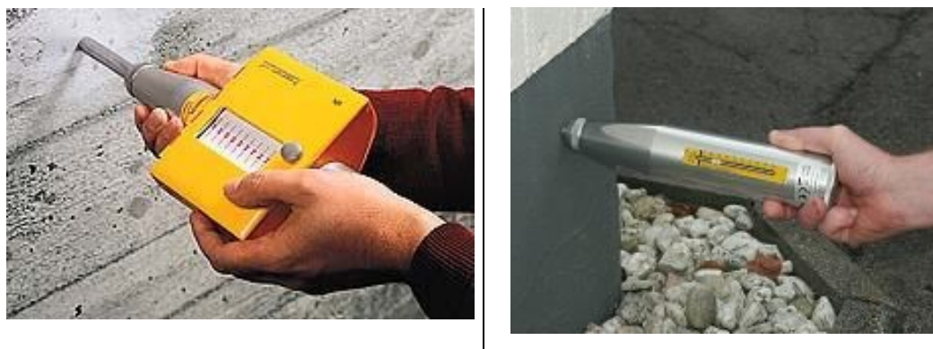
Figura 4.2 – Esclerômetro de reflexão tipo Schmidt.
