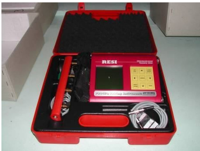
Figura 4.8 – Resi – equipamento para se medir a resistividade.
