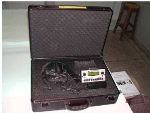
Figura 4.10 – Pacômetro – instrumento para se medir afastamento das armaduras.
