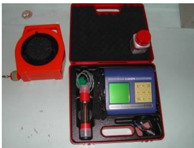
Figura 4.9 – Canin – instrumento para análise de corrosão.
