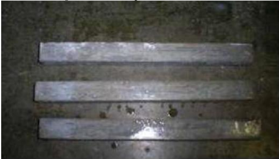
Figura 13 - Barras de argamassa utilizadas no ensaio
