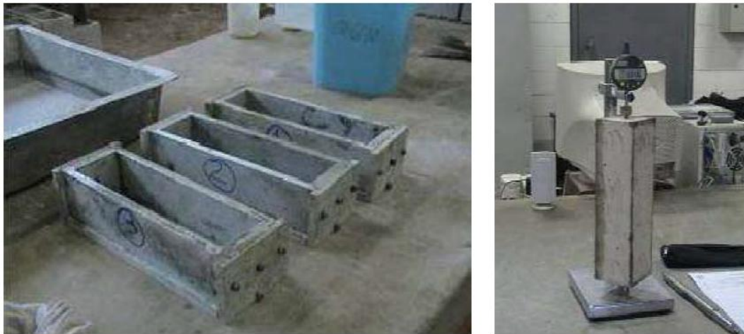
Figura 14 - Moldes e o instrumento de leitura usado no método
