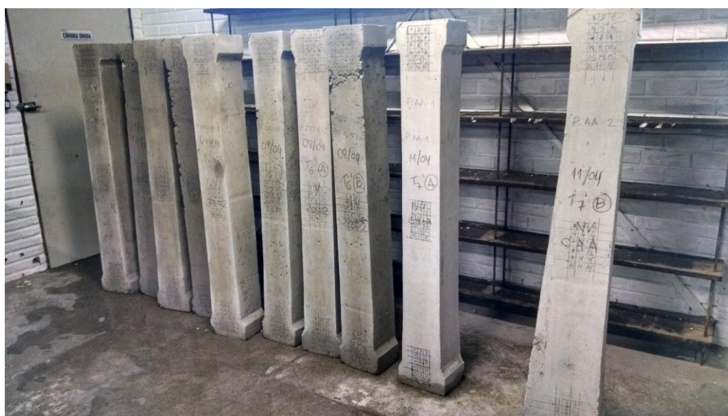
Figura 4: Pilares moldados em laboratório
