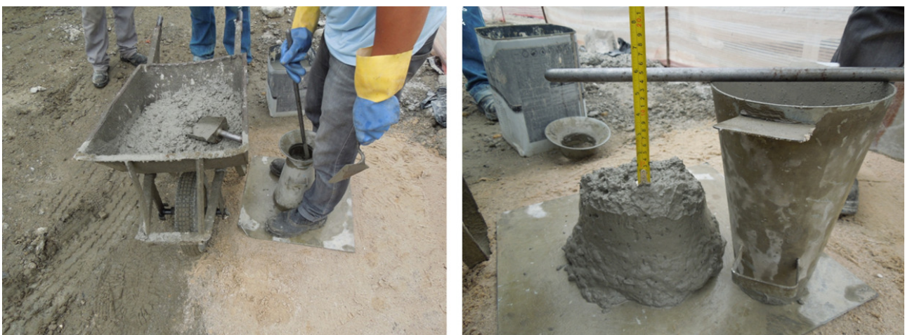
Figura 9 – Detalhe do ensaio de abatimento e do aspecto visual do concreto utilizado no capeamento de lajes pré-fabricadas.
