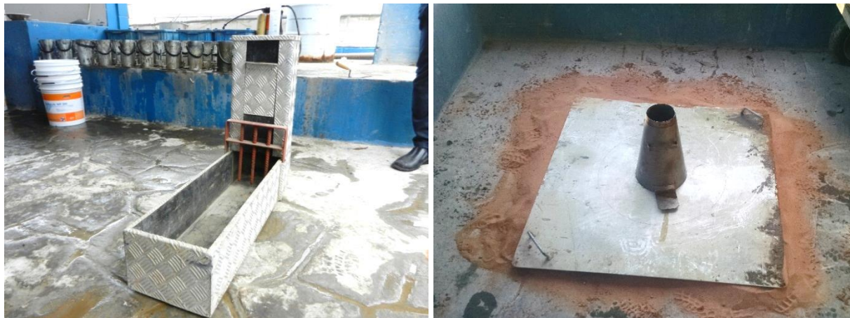
Figura 3 – Detalhe da Caixa L e do equipamento para ensaio de slump flow .
