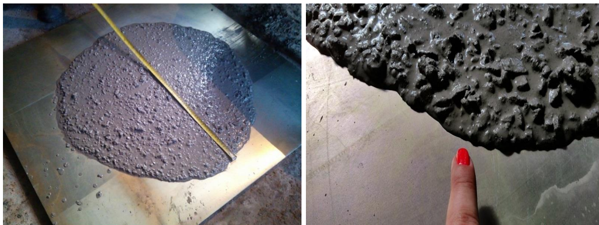
Figura 4 – Detalhe do ensaio de slump flow e aspecto do concreto, sem exsudação.
