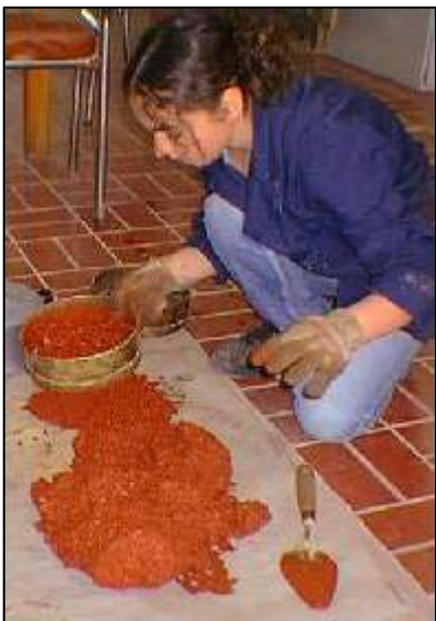
Figura 3.10 Procedimiento de tamizado del hormigón y dispositivo de medición de la fuerza de penetración
