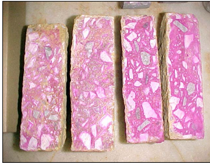
Figura 3.17 Probetas de hormigón con pigmento amarillo con aplicación de fenofaleína en la que se aprecia el frente de carbonatación
