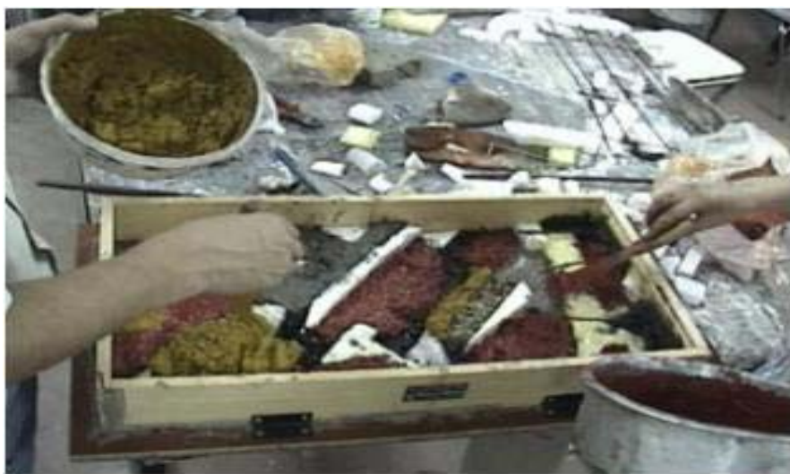
Fig. 5 Compactación del hormigón coloreado (Año 2002)
