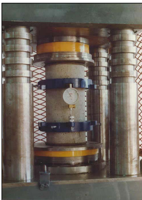
Figura 3.12 Probeta de hormigón con el equipo para la determinación del módulo de elasticidad estático
