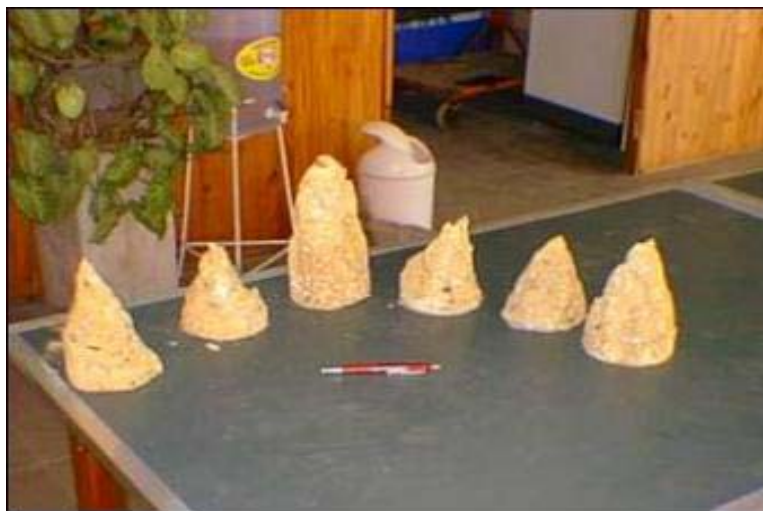
Figura 3.11 Rotura normal de probetas de hormigón con pigmento amarillo sometidas al ensayo de compresión
