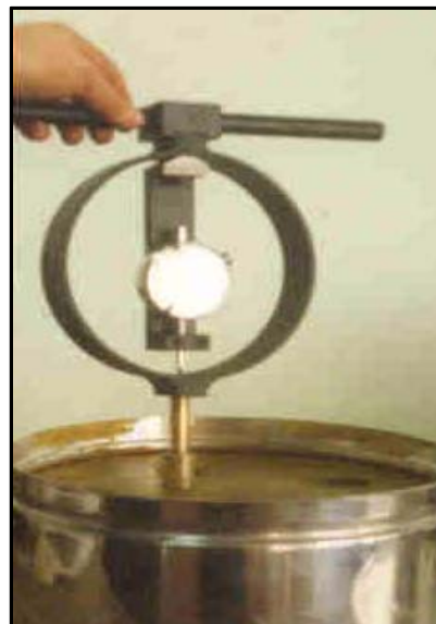
Figura 3.10 Procedimiento de tamizado del hormigón y dispositivo de medición de la fuerza de penetración
