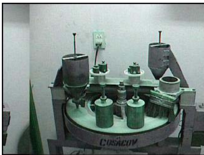
Figura 3.18 Máquina de Dorry. Detalle de los portamuestras y las sobrepesas necesarias para garantizar la presión indicada en la norma
