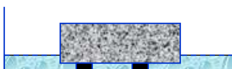
Figura 4 Esquema de muestra sometida a ensayo de succión capilar
