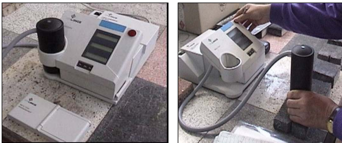
Figura 3.20 En la fotografía izquierda se observa el equipo con la sonda, el display y la placa de calibración y en la derecha, la determinación de las lecturas
