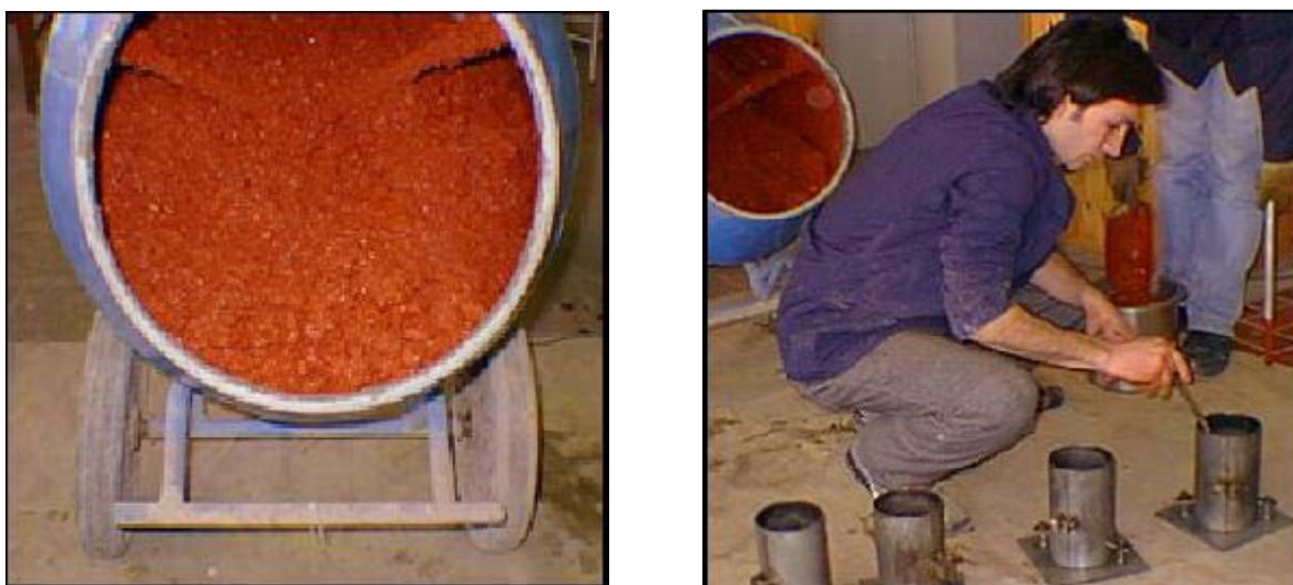
Figura 3.6 Moldeo de probetas cilíndricas con hormigón pigmentado rojo
