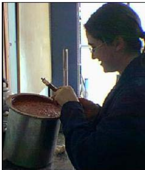
Figura 3.9 Procedimiento para la determinación del agua exudada
