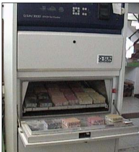
Figura 3.21 Equipo Q SUN 3000 Xenon Test Chamber. Detalle de la placa portamuestras
