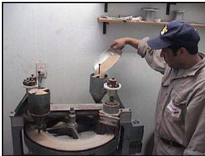
Figura 3.19 Incorporación del abrasivo constituido por arena sílicea
