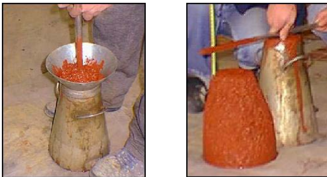
Figura 3.7 Medición del asentamiento en hormigón con pigmento rojo.
