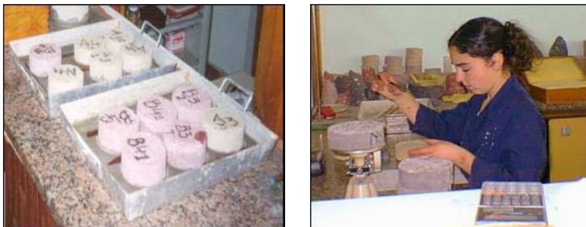
Figura 3.14 Disposición de las probetas durante el ensayo de succión capilar
