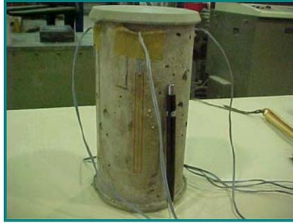
**Figura 3-6** *Corpo-de-prova preparado para o ensaio de módulo de elasticidade*
