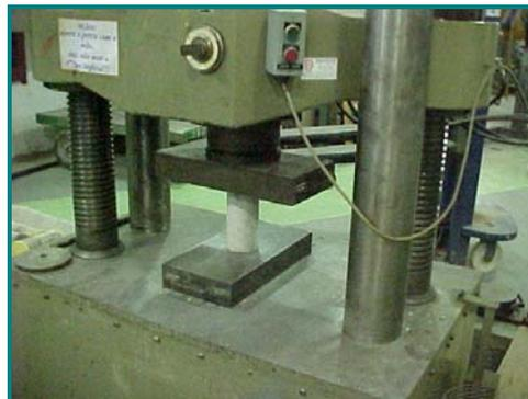
**Figura 3-4** *Ensaio de resistência à compressão axial em corpo-de-prova cilíndrico.*
