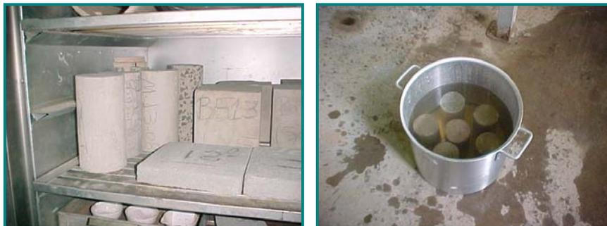
**Figura 3-13** Fases da determinação da absorção de água e índice de vazios: secagem em estufa, saturação em água e fervura.
