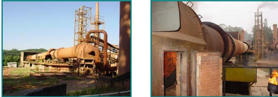
**Figura 2-2** *Vista geral e detalhe do forno rotativo da fábrica brasileira de metacaulim.*
