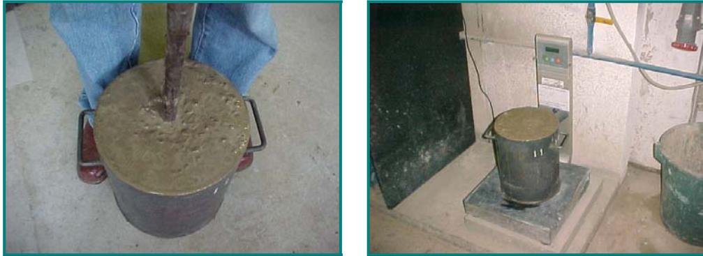
**Figura 3-3** *Determinação da massa específica do concreto no estado fresco. O recipiente é preenchido em duas camadas com vibração e, em seguida, pesado.*
