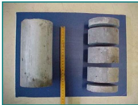
**Figura 3-9** Partição dos corpos-de-prova cilíndricos de 10x20 cm para o ensaio de resistência à penetração de íons cloreto.
