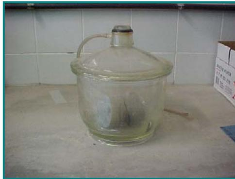
**Figura 3-10** Amostras depositadas no dessecador.
