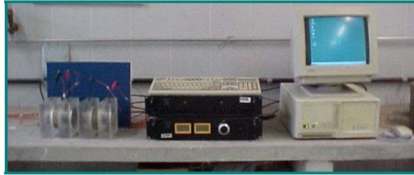
**Figura 3-12** *Ensaio de resistência à penetração de íons cloreto, em andamento.*
