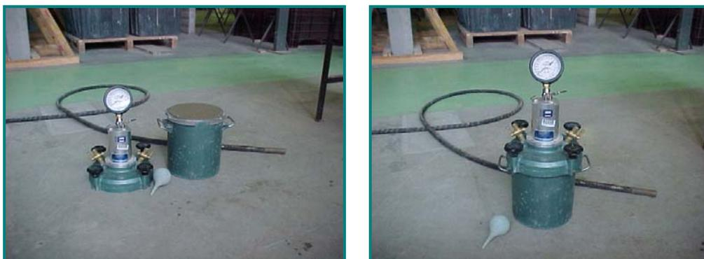
**Figura 3-2** *Ensaio de determinação do teor de ar incorporado. O aparelho aberto já preenchido com concreto e fechado pronto para a determinação.*
