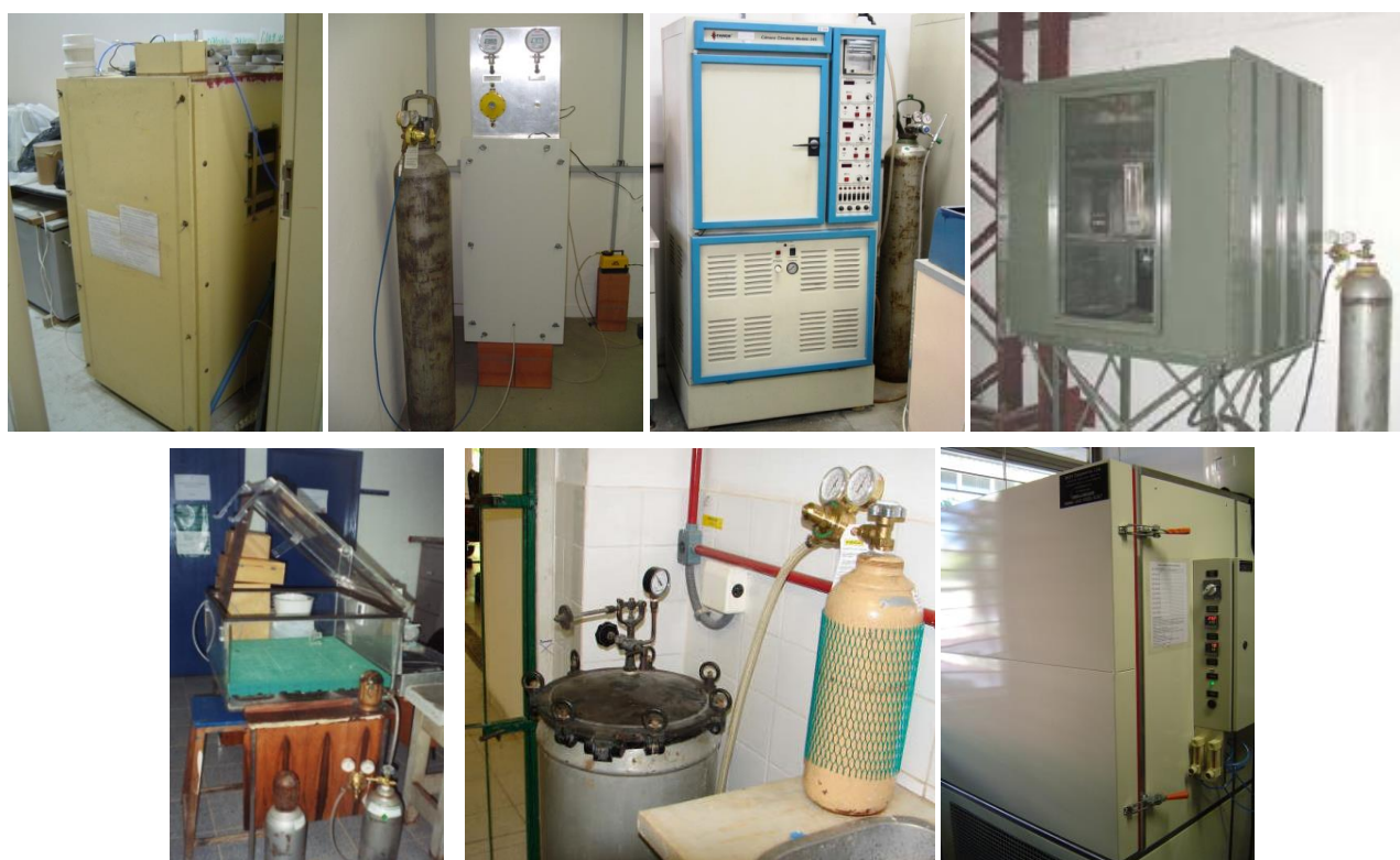
Figura 4 - Câmaras utilizadas em ensaios de carbonatação acelerada.
