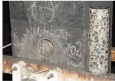
Figura 5 – Aspecto de testemunho extraído (Arquivo LEME/UFRGS).
