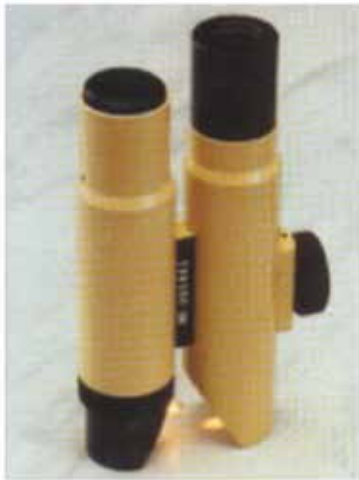
Figura 12 – Aspecto de um fissurômetro ótico tipo lupa com iluminação (Arquivo LEME/UFRGS).
