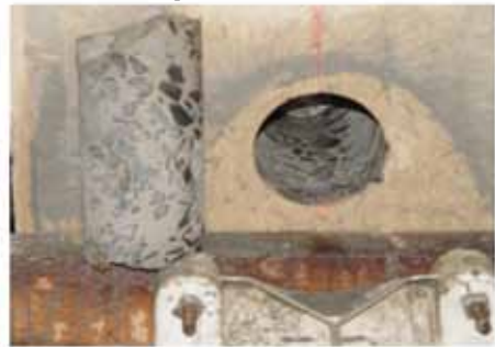
Figura 7 – Aspecto de testemunho com bases irregulares, que devem ser regularizadas (Arquivo LEME/UFRGS).
