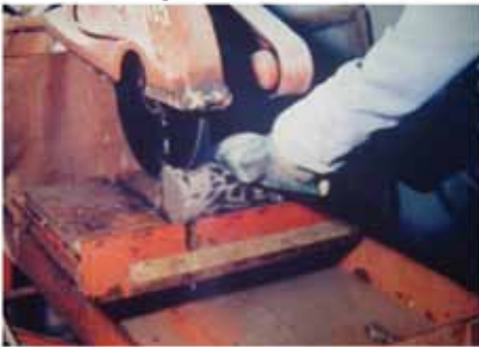
Figura 6 – Corte para regularização do testemunho ou retirada da porção contendo armaduras (Arquivo LEME/UFRGS).
