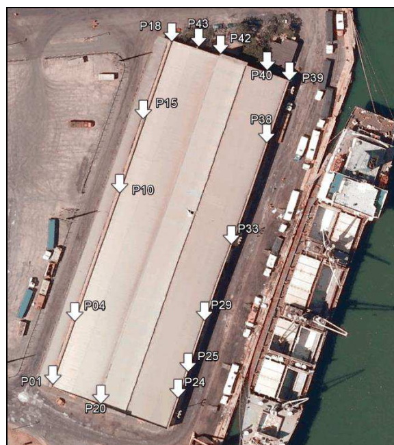
Foto 4.24 - Posicionamento dos pilares ensaiados com o esclerômetro.
