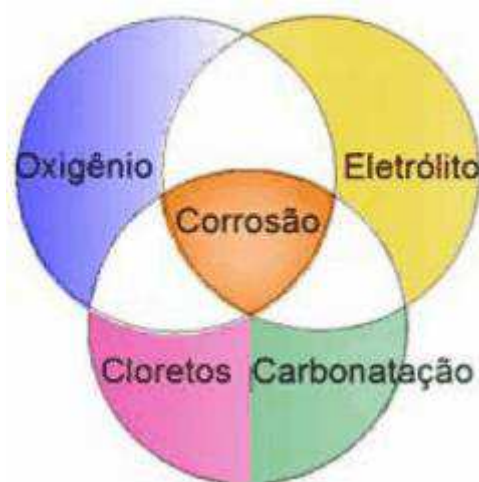
Figura 2.10 – Representação gráfica das condições necessárias para o desenvolvimento do processo de corrosão (TORRES, 2011).
