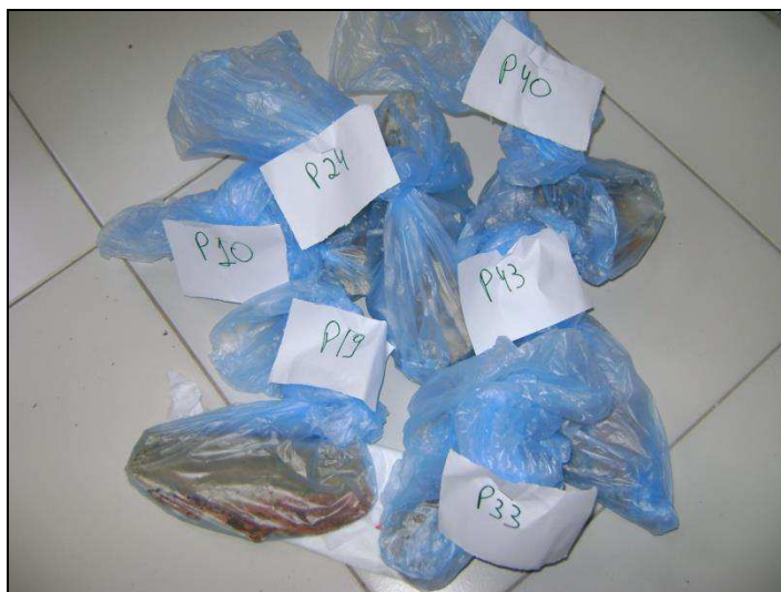
Foto 4.35 – Amostras de concreto identificadas para o ensaio de teor de cloreto em relação à massa de concreto.
