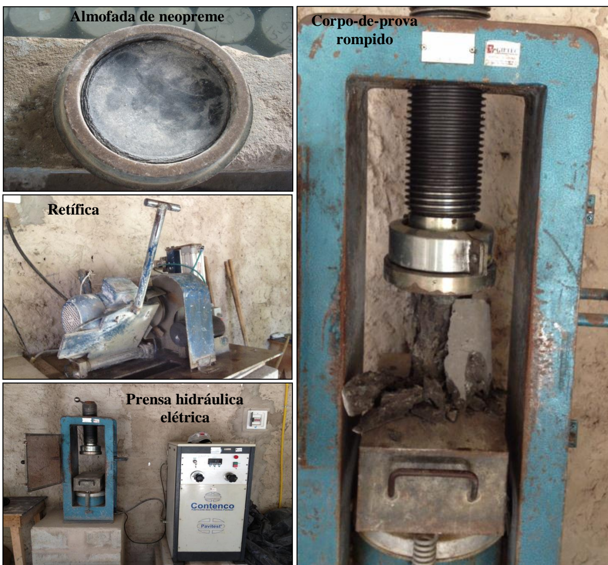
Figura 102 – Ensaio de resistência à compressão axial
