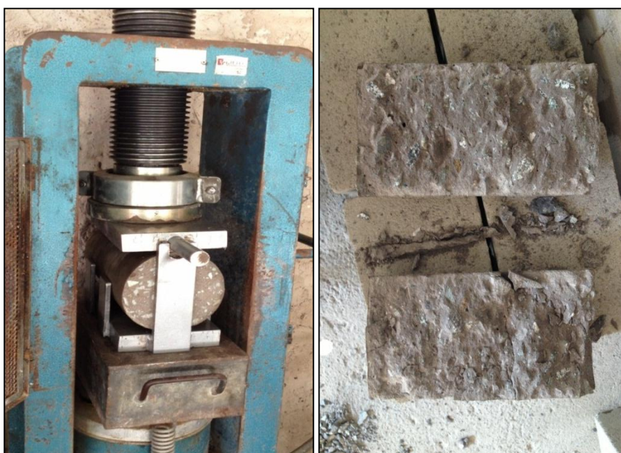
Figura 103 – Ensaio de resistência à tração por compressão diametral
