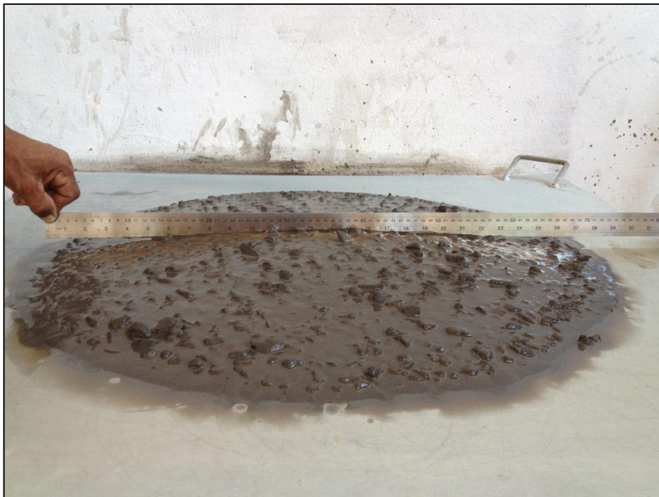
Figura 41 – Medindo o diâmetro de espalhamento
