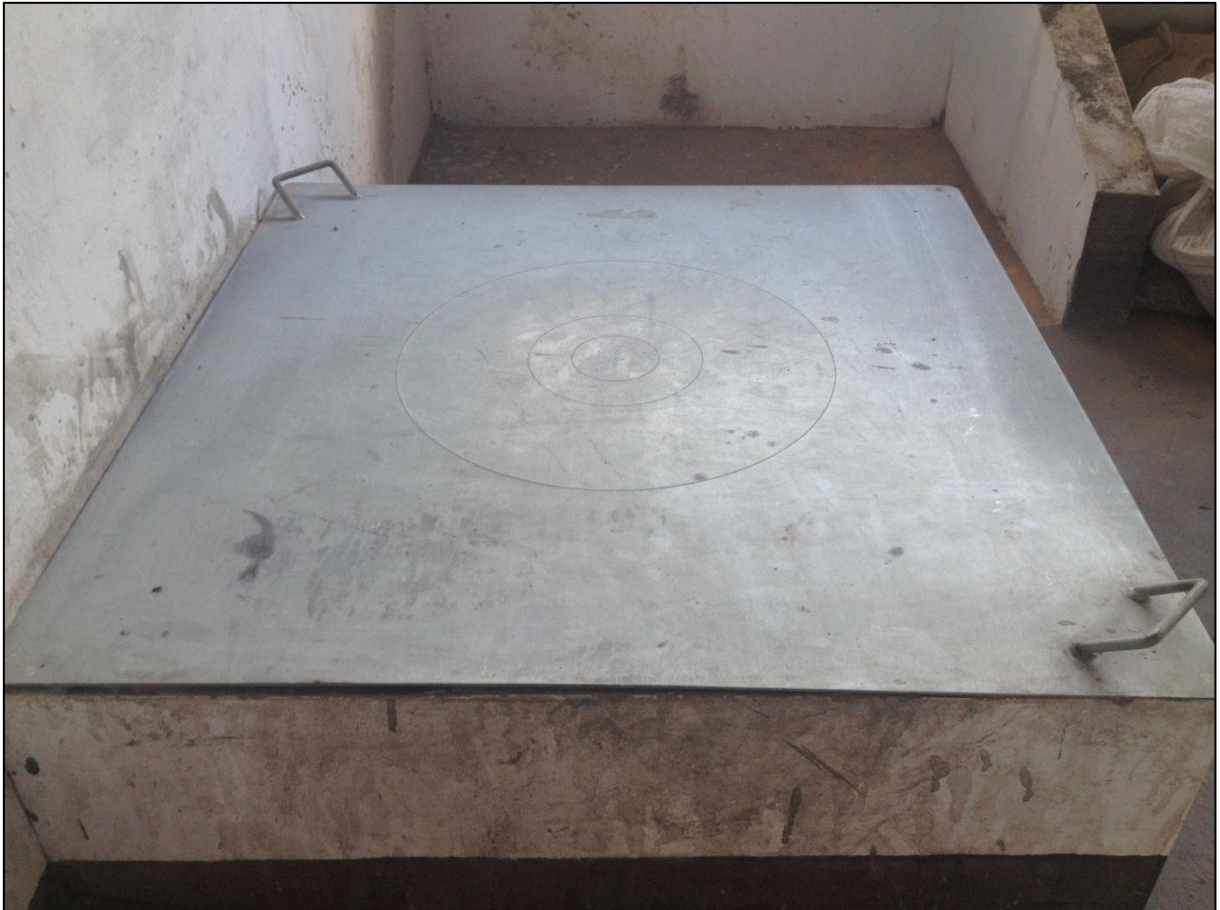
Figura 38 – Base do ensaio de espalhamento
