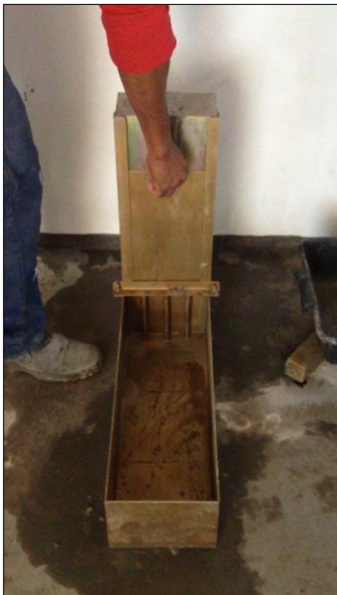
Figura 98 – Ensaio da Caixa L
