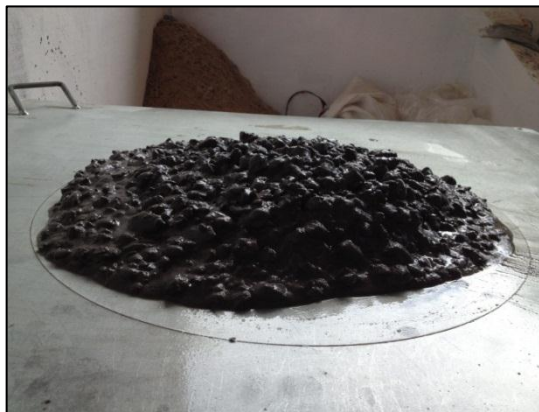
Figura 42 – Concreto pouco fluido e apresentando sinais de segregação
