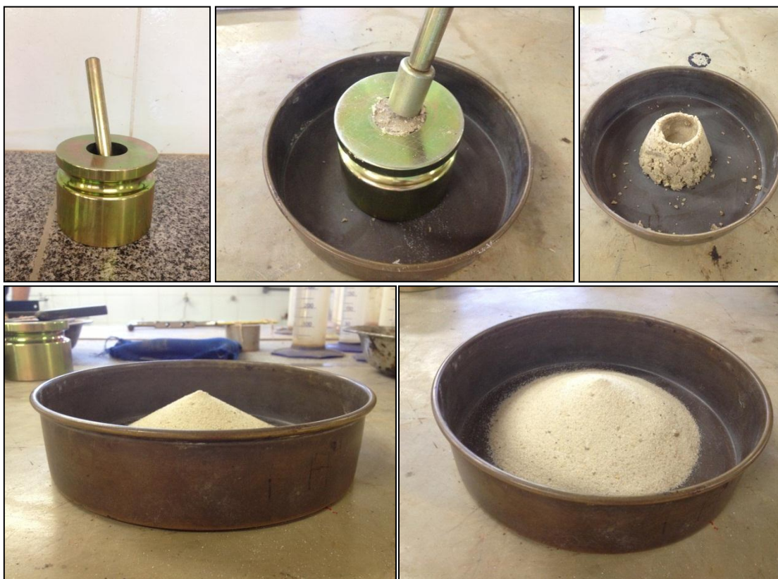
Figura 77 – Determinação da absorção da areia
