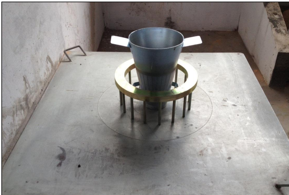
Figura 46 – Vista em perspectiva do posicionamento do molde e do anel J
