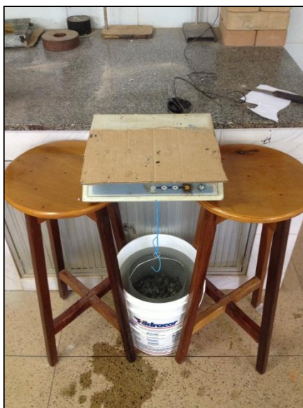
Figura 86 – Determinação da massa específica e absorção da brita 1 e brita 0
