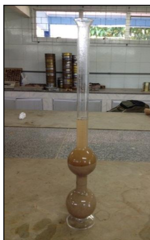
Figura 76 – Determinação da massa específica da areia
