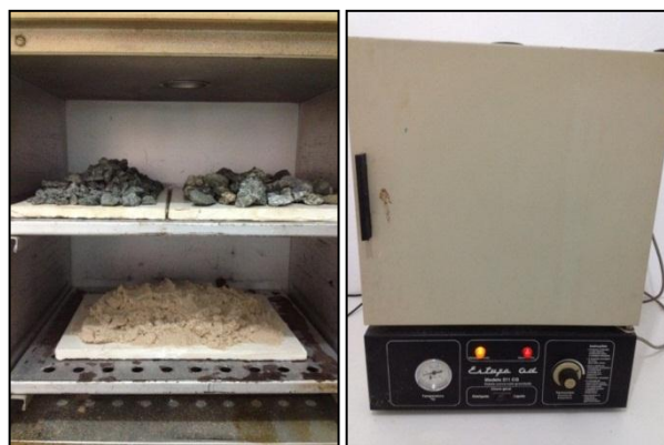
Figura 92 – Determinação do teor de umidade dos materiais
