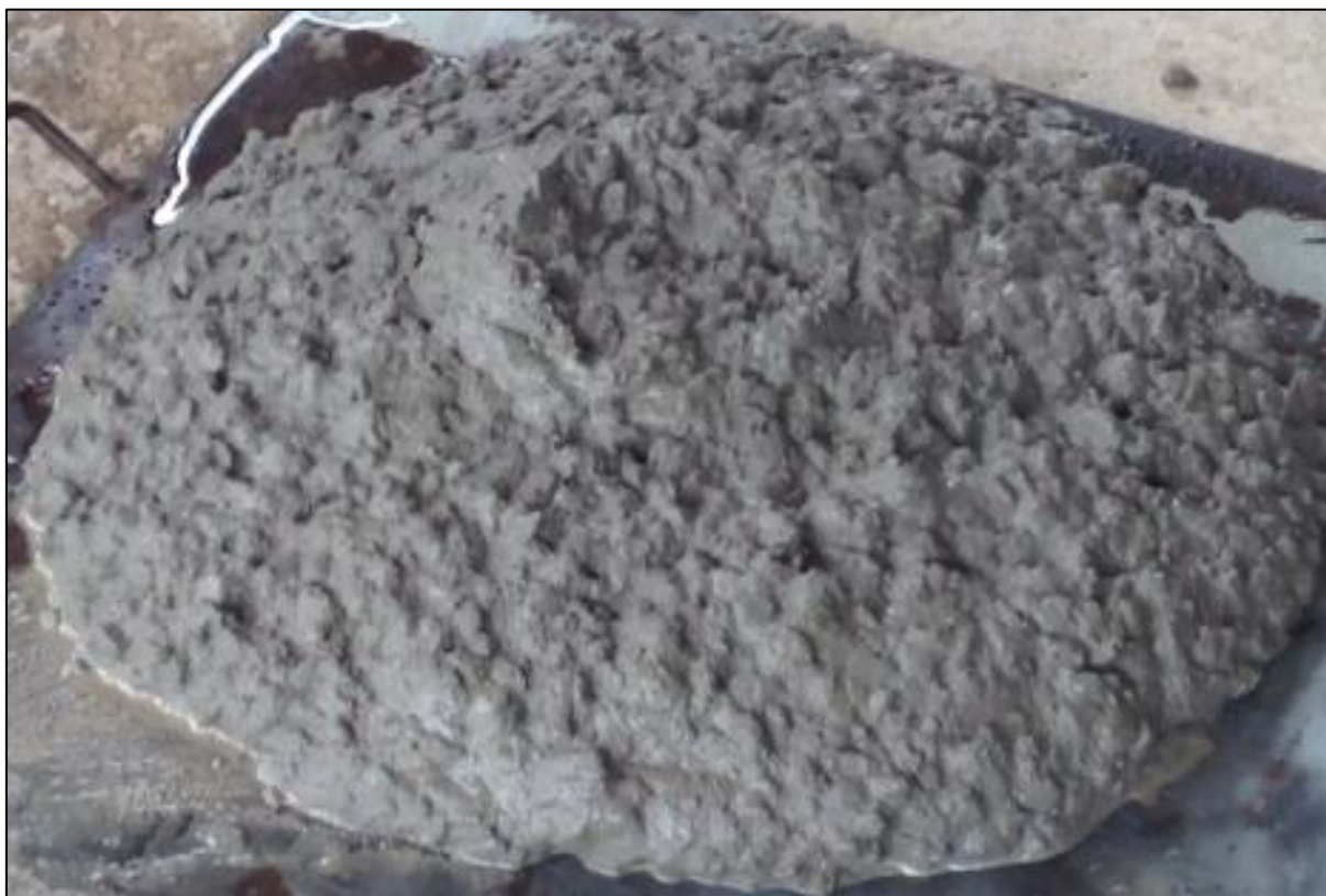
Figura 116 – Aspecto do CAA no ensaio de espalhamento
