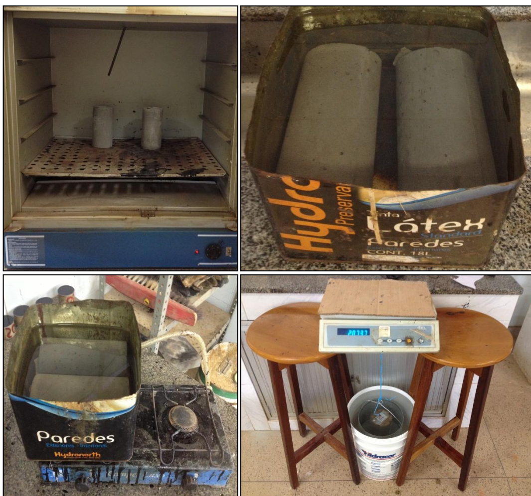
Figura 104 – Ensaio da absorção de água e índice de vazios por imersão
