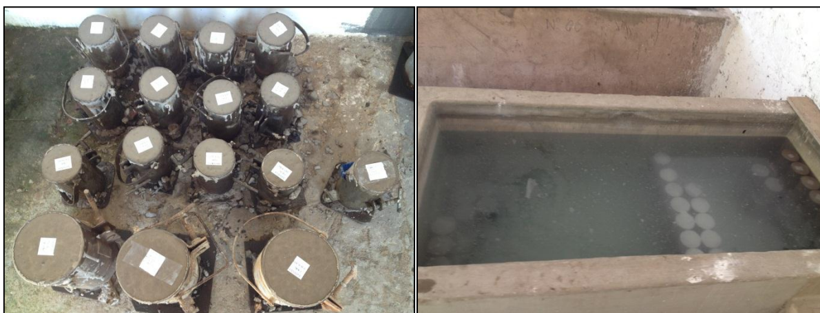
Figura 101 – Moldagem e Cura dos corpos-de-prova
