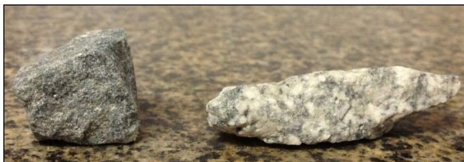
Figura 84 – Aspecto visual da forma dos grãos da brita 1 e brita 0
