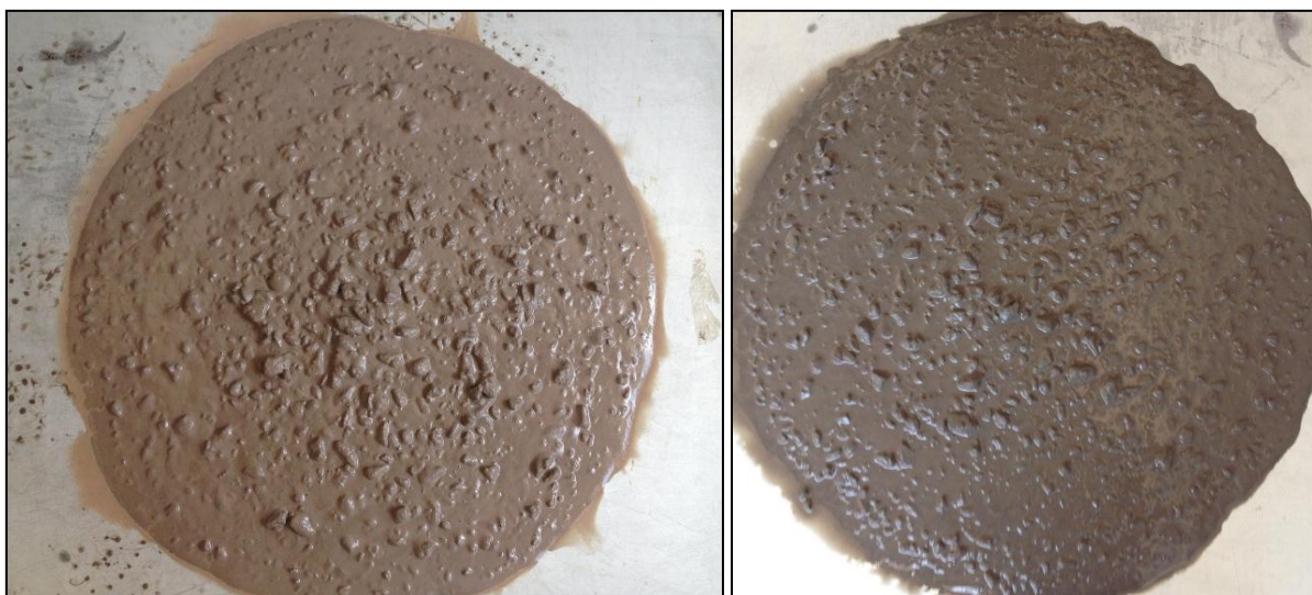
Figura 107 – Aspecto do CAA no ensaio de espalhamento e tempo de escoamento
