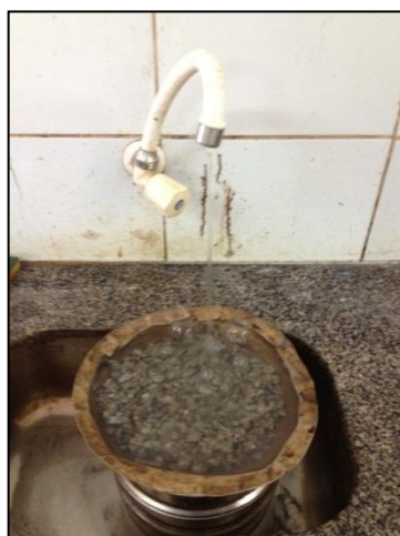
Figura 87 – Determinação do teor de material pulverulento da brita 1 e brita 0
