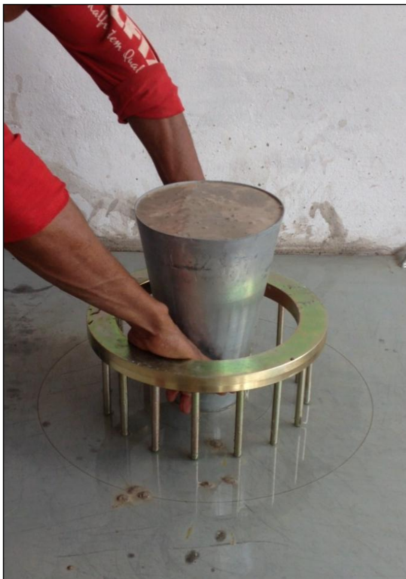
Figura 97 – Ensaio do Anel J
