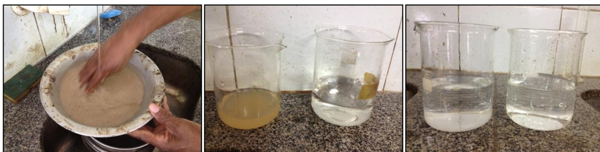
Figura 78 – Determinação do teor de material pulverulento da areia
