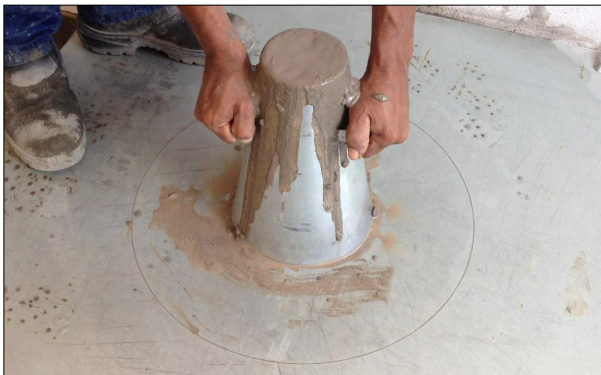
Figura 96 – Ensaio de espalhamento e do tempo de escoamento
