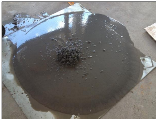
Figura 43 – Concreto muito fluido e com segregação visível
