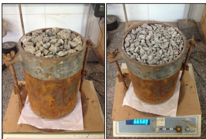
Figura 85 – Determinação da massa unitária da brita 1 e brita 0
