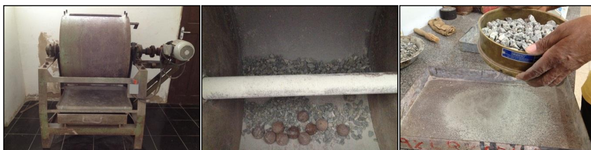
Figura 88 – Determinação da resistência à abrasão da brita 1 e brita 0
