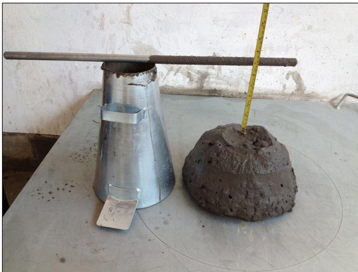
Figura 106 – Ensaio de consistência pelo abatimento do tronco de cone
