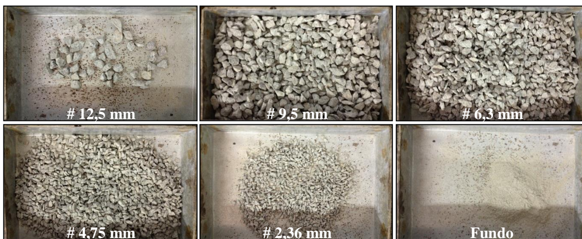
Figura 82 – Aspecto visual da distribuição granulométrica da brita 0
