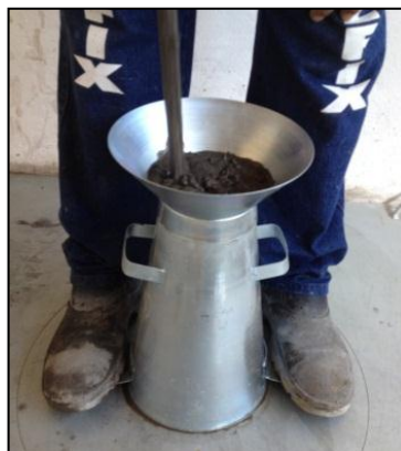
Figura 95 – Ensaio de consistência pelo abatimento do tronco de cone
