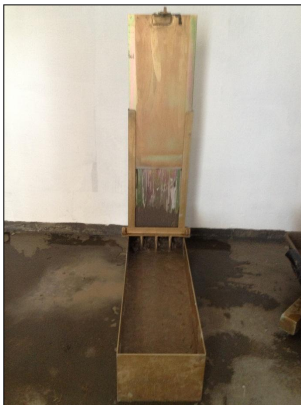
Figura 109 – Aspecto do CAA no ensaio da Caixa L
