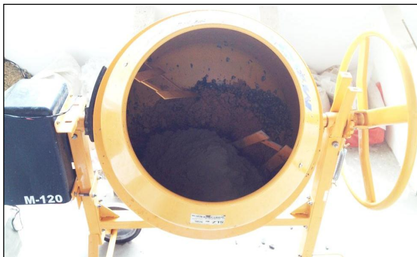
Figura 94 – Mistura dos materiais na betoneira basculante
