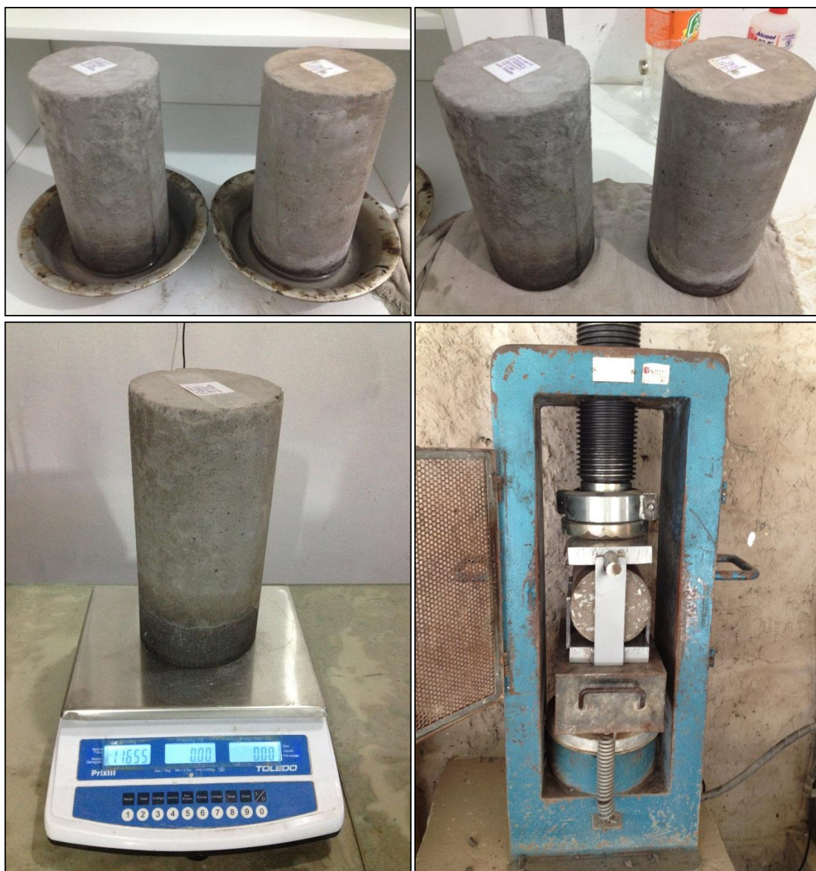
Figura 105 – Ensaio da absorção de água por capilaridade
