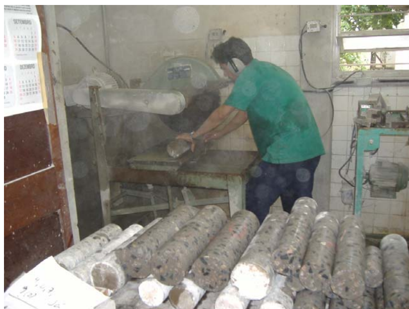
Figura 3.23 – Inspeção prévia e preparação por corte com serra diamantada de testemunhos de diversos diâmetros – Laboratório da UFPE – (foto de 2004)
