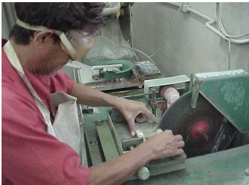
Figura 3.22 – Inspeção prévia e preparação por corte com serra diamantada de testemunho \Phi=2,5\text{cm} – Laboratório da UFPE – (foto de 2004)
