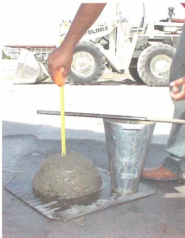
Figura 3.13 – Determinação da consistência pelo abatimento do tronco de cone – pátio da central dosadora da MARÉ CIMENTO Ltda. - POLIMIX (foto de 2004)
