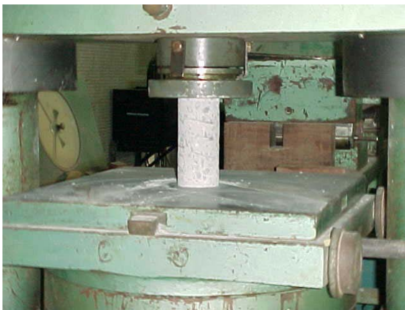
Figura 3.41 – Ensaio de ruptura \Phi=10,0\text{cm} - laboratório da UFPE - (foto de 2004)
