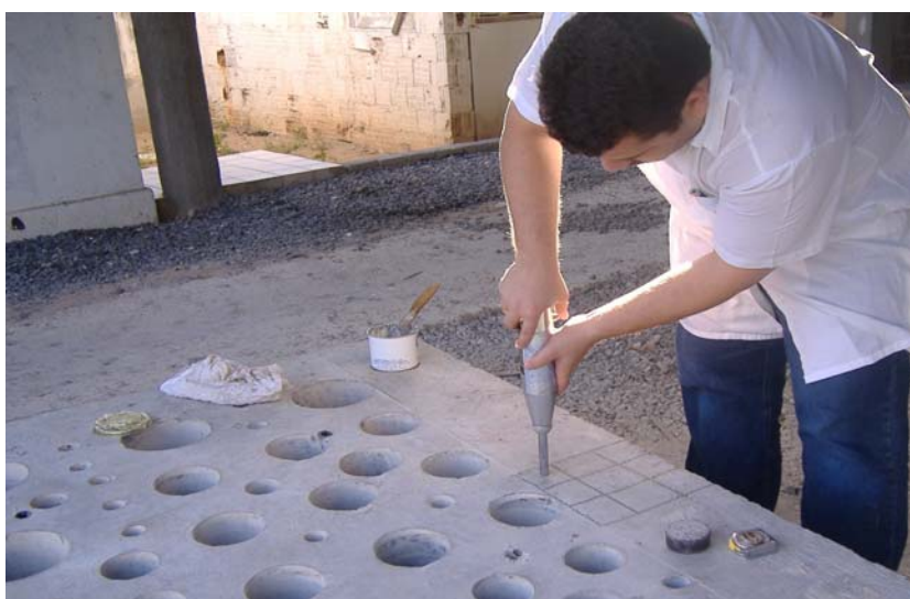
Figura 3.32 – Ensaio de dureza esclerométrica em bloco no canteiro-de-obras do edifício Sansara – equipamento SOILTEST - Model CT-320AM do Laboratório da Universidade Católica/PE (foto de 2005)
