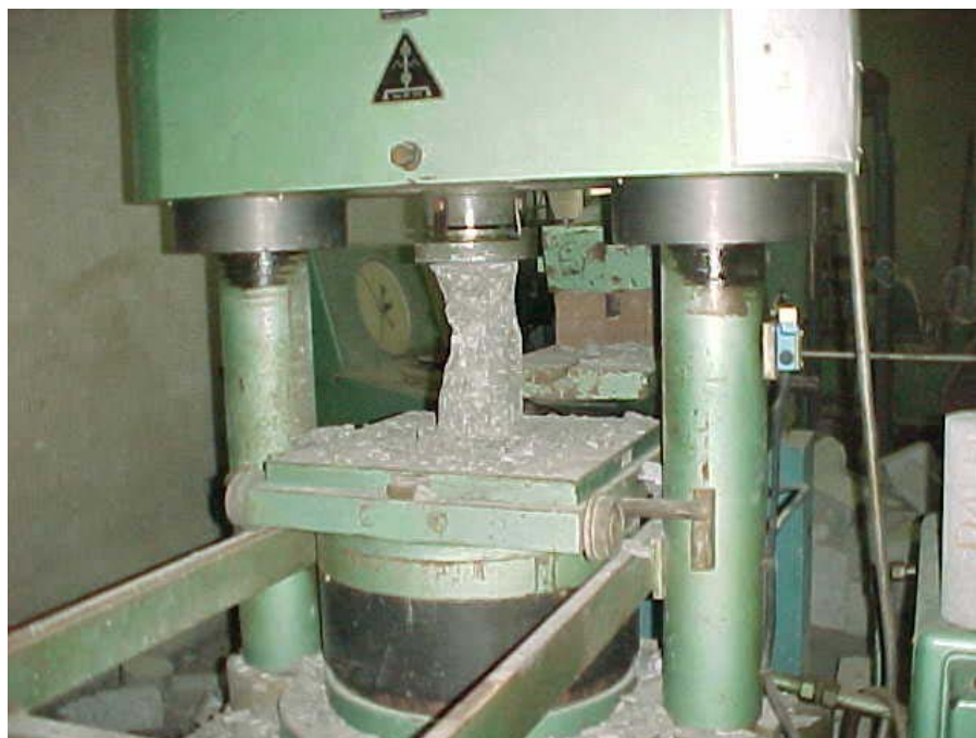
Figura 3.44 – Testemunho de \Phi=15,0\text{cm} após ruptura - Laboratório da UFPE (foto de 2004)
