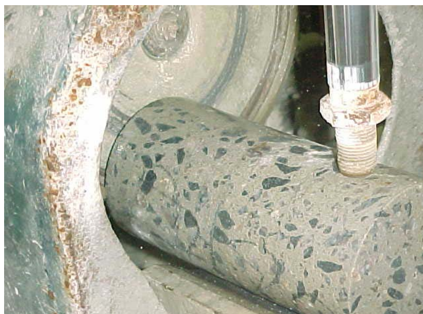
Figura 3.25 – Retificação das faces dos testemunhos – Laboratório da empresa TECOMAT – (foto de 2004)
