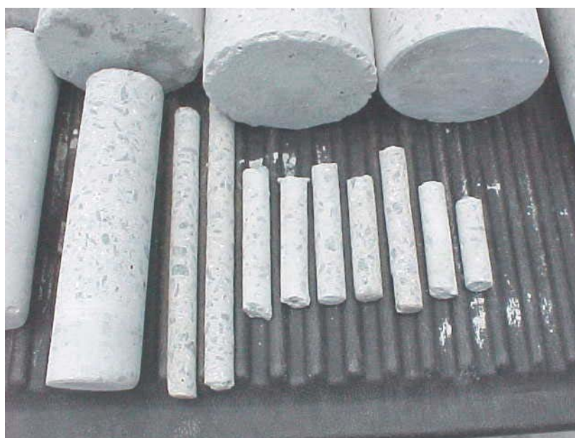
Figura 3.36 – Detalhe dos testemunhos extraídos de \Phi=2,5\text{cm} com algumas quebras esporádicas – pátio da central dosadora da MARÉ CIMENTO Ltda. - POLIMIX (foto de 2004)
