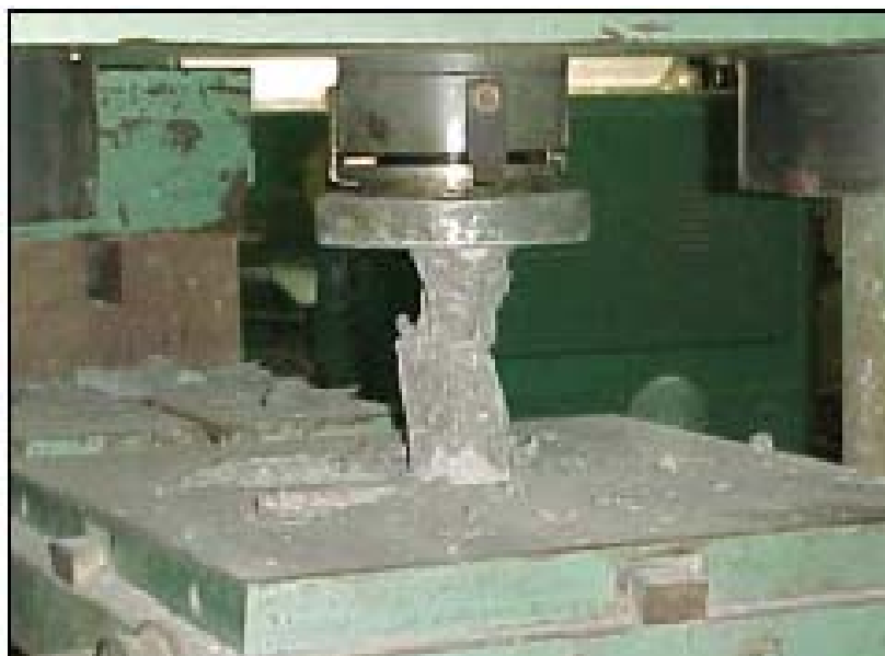
Figura 3.42 – Testemunho de \Phi=10,0\text{cm} após ruptura - laboratório da UFPE - (foto de 2004)
