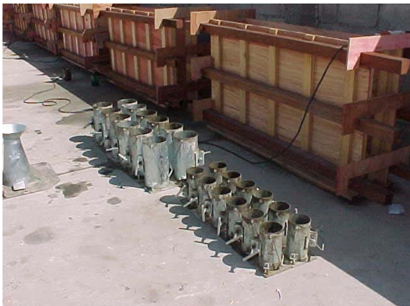
Figura 3.14 – Formas padronizadas de 15cm x 30cm e 10cm x 20cm para moldagem dos corpos-de-prova no pátio da central MARÉ CIMENTO Ltda. - POLIMIX (foto de 2004)
