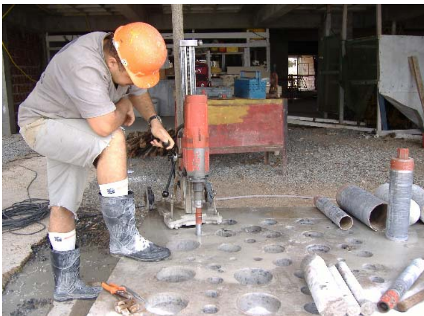
Figura 3.21 – Extração de testemunhos \Phi=2,5\text{cm} no canteiro-de-obras do edifício Sansara (foto de 2005)
