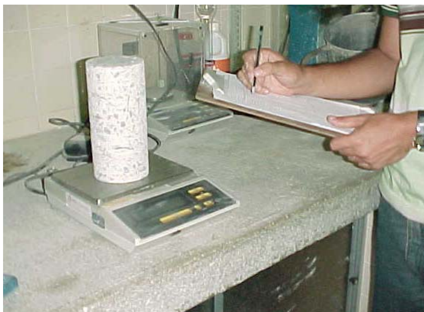
Figura 3.26 – Determinação da massa específica aparente por pesagens dos corpos-de-prova e testemunhos de 10x20cm – Laboratório da Universidade Católica/PE (foto de 2004)
