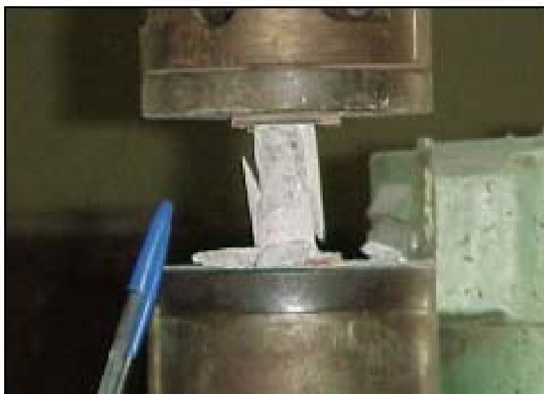
Figura 3.38 – Ensaio de testemunho de \Phi=2,5\text{cm} – após a ruptura - Laboratório da UFPE - (foto de 2004)
