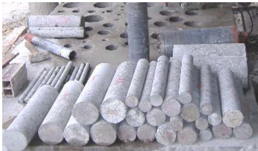
Figura 3.35 – Testemunhos extraídos de diversos diâmetros íntegros – canteiro-de-obras do edifício Sansara (foto de 2004)
