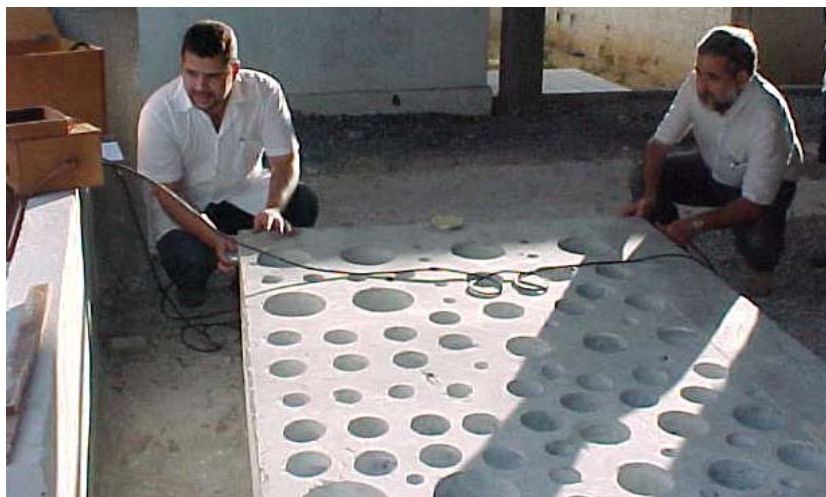
Figura 3.31 – Ensaio de velocidade ultrassônica em bloco no canteiro-de-obras do edifício Sansara – equipamento PUNDIT do Laboratório da Universidade Católica/PE (foto de 2005)
