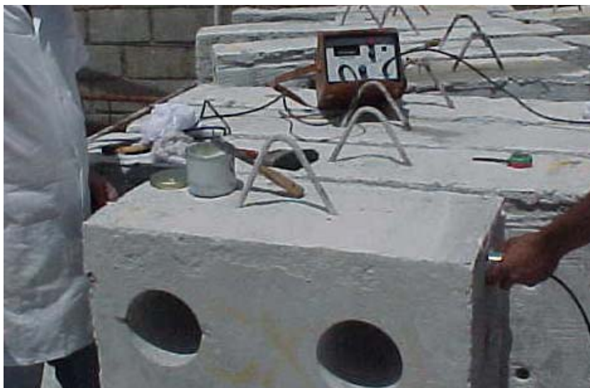
Figura 3.29 – Ensaio de velocidade ultrassônica nos blocos no pátio da central dosadora da MARÉ CIMENTO Ltda. - POLIMIX – equipamento PUNDIT do Laboratório da Universidade Católica/PE (foto de 2004)
