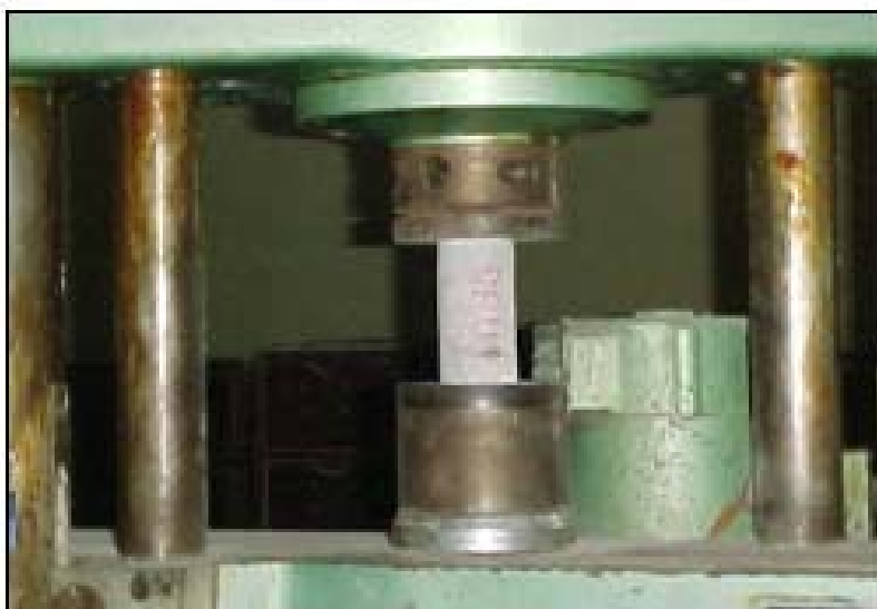
Figura 3.39 – Ensaio de ruptura para os testemunhos de \Phi=5,0\text{cm} - Laboratório da UFPE - (foto de 2004)
