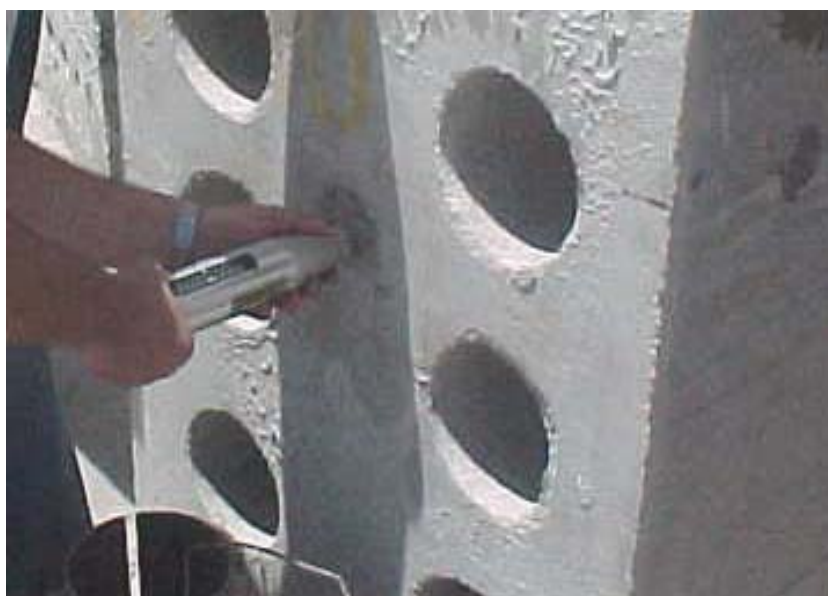
Figura 3.28 – Ensaio de dureza esclerométrica em bloco no pátio da central dosadora da MARÉ CIMENTO Ltda. - POLIMIX – equipamento SOILTEST - Model CT-320AM do Laboratório da Universidade Católica/PE (foto de 2004)
