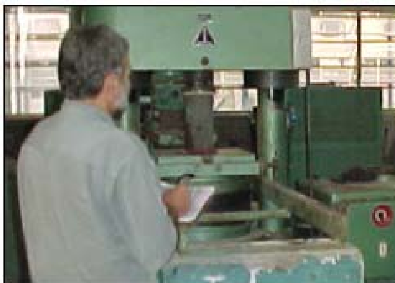
Figura 3.43 – Ensaio de ruptura de \Phi=15,0\text{cm} - Laboratório da UFPE (foto de 2004)
