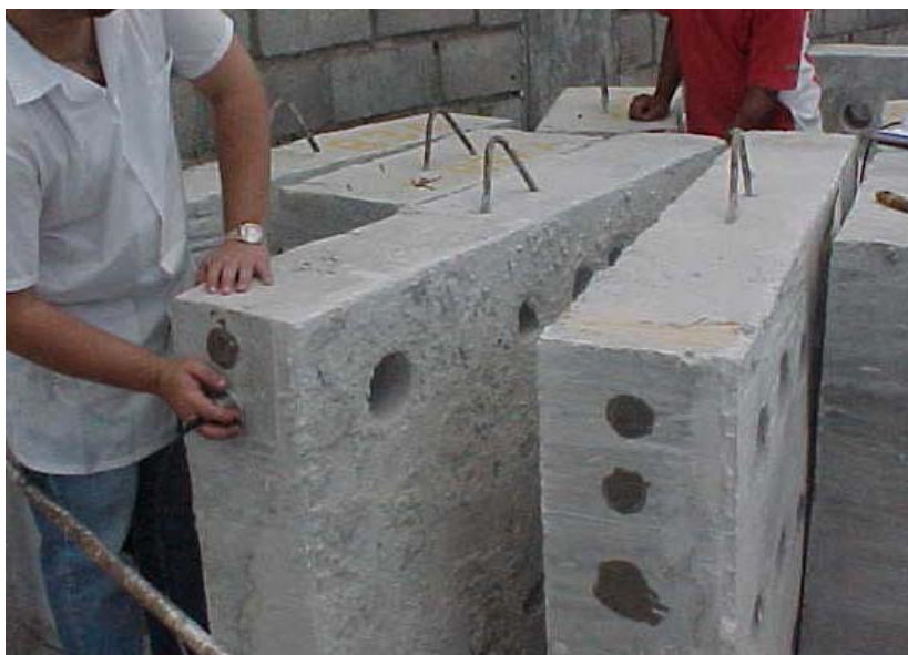
Figura 3.30 – Ensaio de velocidade ultrassônica nos blocos no pátio da central dosadora da MARÉ CIMENTO Ltda. - POLIMIX – equipamento PUNDIT do Laboratório da Universidade Católica/PE (foto de 2004)
