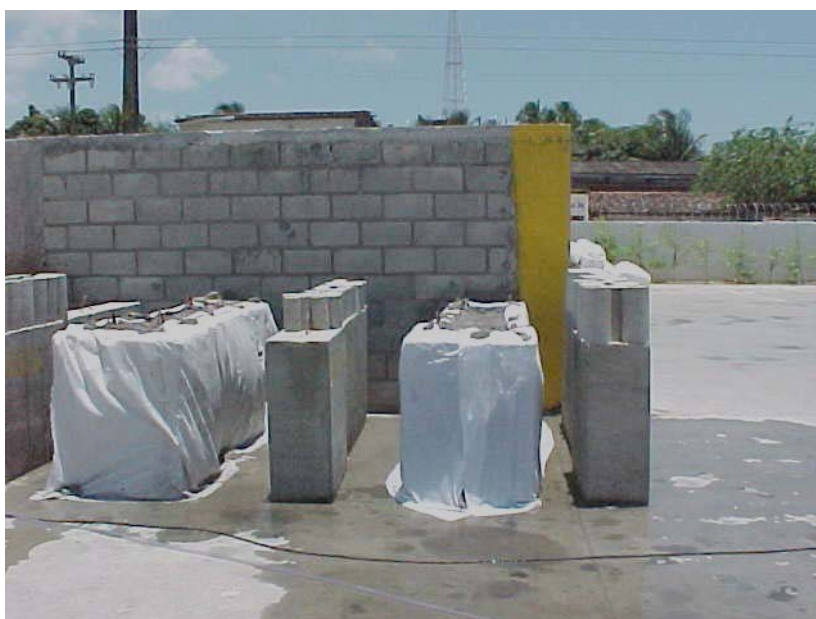
Figura 3.12 – Cura úmida e cura ao ar nos blocos no pátio da central dosadora da MARÉ CIMENTO Ltda. - POLIMIX (foto de 2004)
