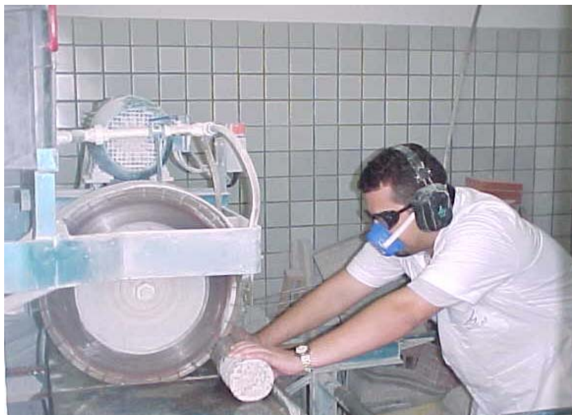
Figura 3.24 – Inspeção prévia e preparação por corte com serra diamantada – Laboratório da Universidade Católica /PE – (foto de 2005)
