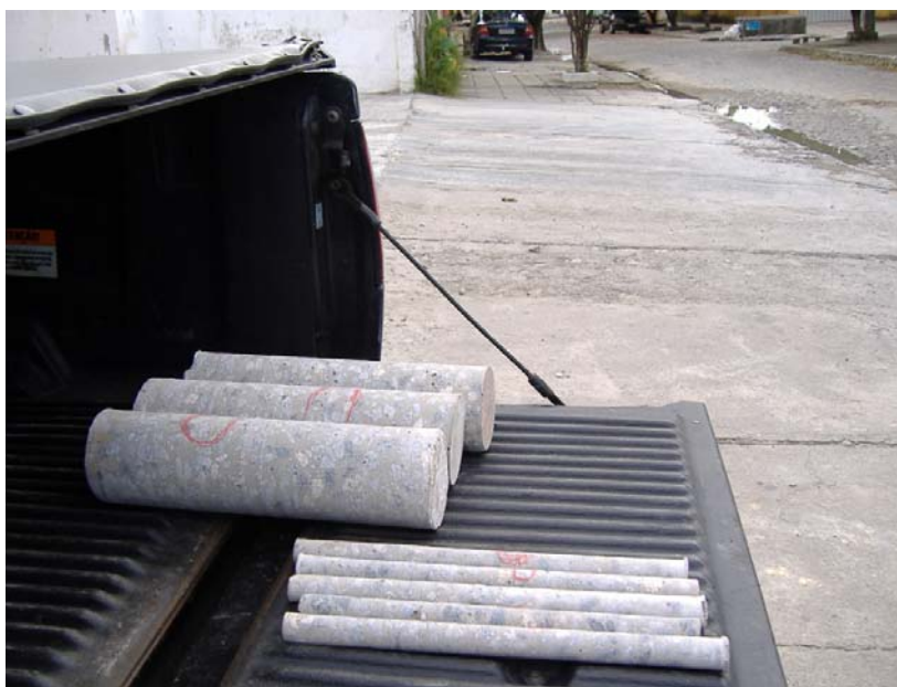
Figura 3.33 – Testemunhos extraídos \Phi = 10\text{cm} e \Phi = 2,5\text{cm} - entrada do pátio da central dosadora da MARÉ CIMENTO Ltda. - POLIMIX (foto de 2004)
