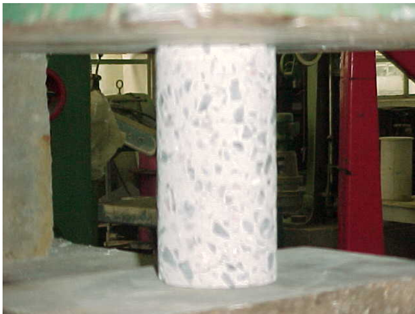
Figura 3.40 – Ensaio de ruptura de testemunho de \Phi=7,5\text{cm} - Laboratório da UFPE - (foto de 2004)
