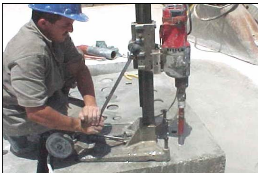
Figura 2 – Extração de testemunhos nos blocos
