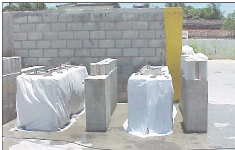
Figura 1 – Blocos sendo curados úmidos e ao ar
