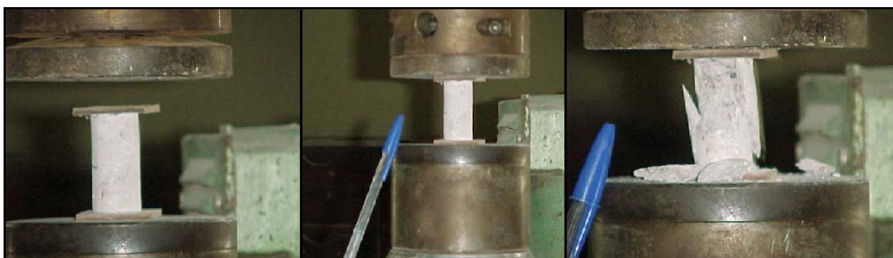
Figura 5 – Testemunho antes e após ruptura, diâmetro de 5 cm
