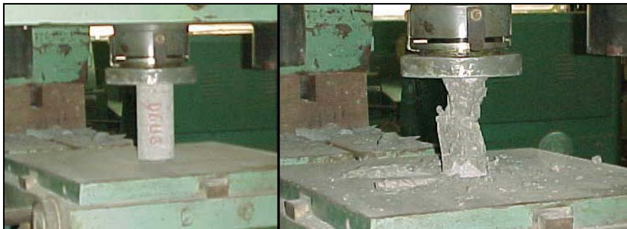
Figura 3 – Testemunho antes e após ruptura, diâmetro de 10 cm
