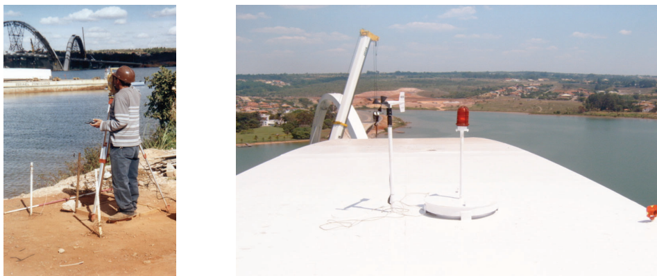
Figura 15. Monitoramento topográfico e o anemômetro instalado no arco central (ALMEIDA et. al. , 2006).
