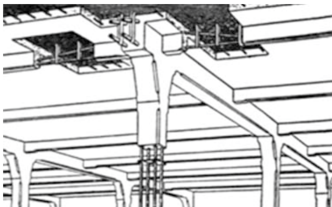
Figura 7. Dibujo de un diseño típico y la construcción de edificios con estructuras de concreto de acuerdo con la patente Hennebique en 1892.
