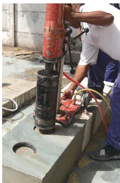
Figuras 7 e 8 – Extração de testemunhos da laje
