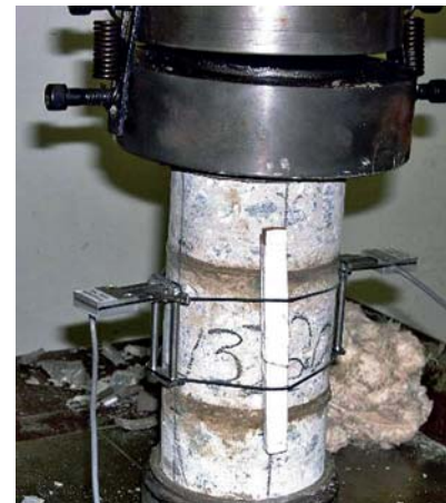
Figura 16 – Aspectos dos ensaios de módulo
