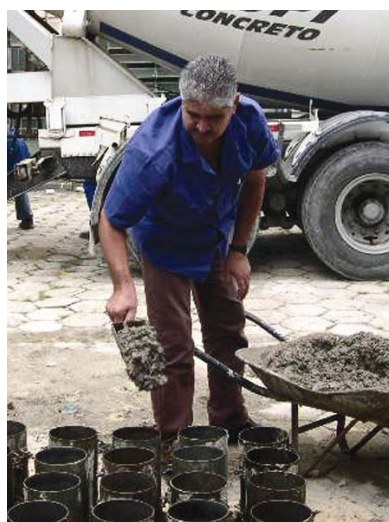
Figura 5 – Moldagem dos corpos-de-prova e dos protótipos
