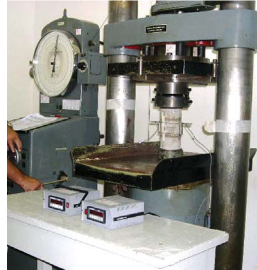
Figura 15 – Detalhe dos extensômetros
