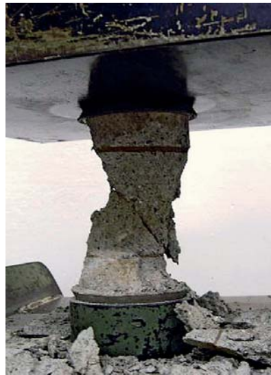
Figura 14 – Aspecto do ensaio a compressão
