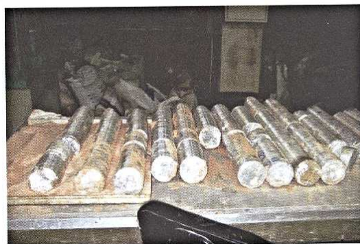
Figura 9 – Extração de testemunhos cilíndricos de concreto da estrutura para avaliação da resistência potencial equivalente do concreto à compressão
