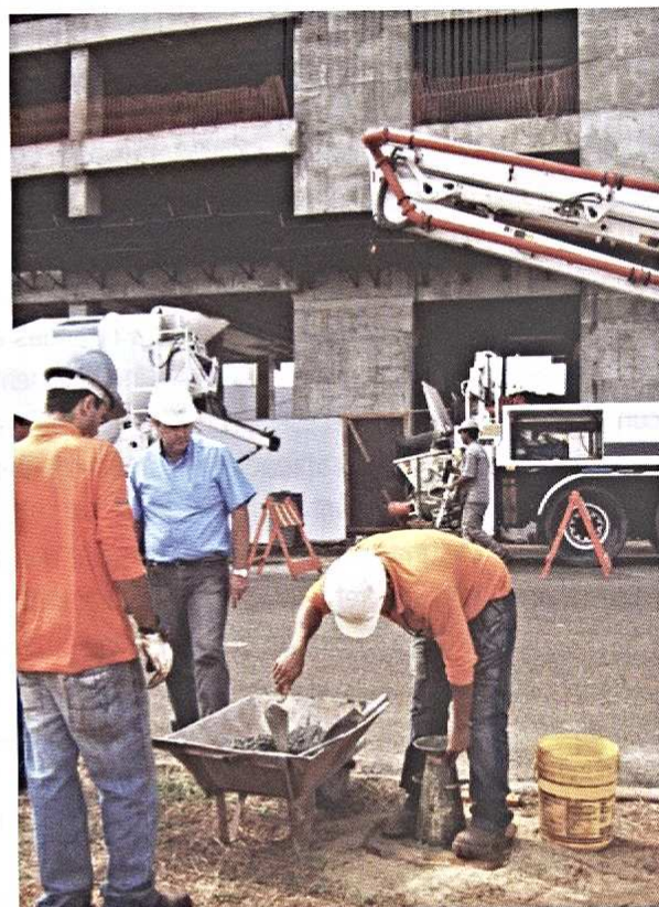
Figura 8 – Ensaio para avaliação da consistência do concreto fresco através do ensaio de abatimento do tronco de cone ABNT NBR NM 67:1998 (acervo PhD Engenharia)
