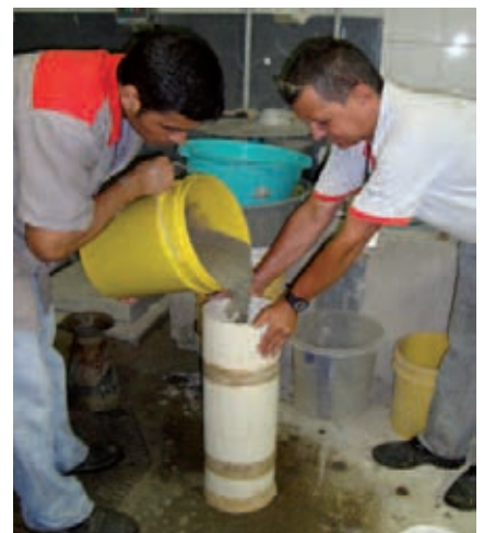
Fig. 4: a) slump-flow; b) funil V; c) caixa L e d) coluna de segregação
