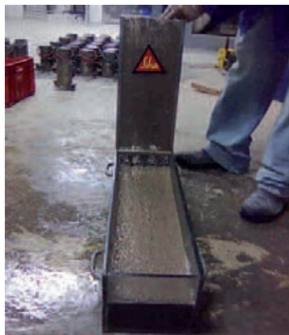
Fig. 4: a) slump-flow; b) funil V; c) caixa L e d) coluna de segregação
