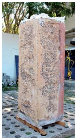
O pilar com 2,5 metros de altura antes de ser levado ao forno e o resultado depois com 95% da sua integridade
