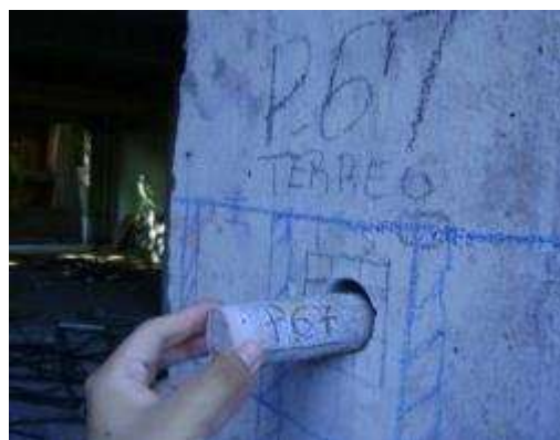
Figura 3.2. Extração de testemunho sendo realizada.
