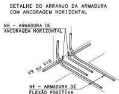
Figura 5.5 Armadura de ancoragem horizontal em laço.
