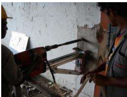
Figura 3.2. Extração de testemunho sendo realizada.
