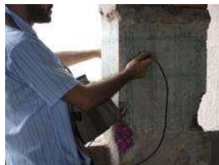
Figura 3.3 Posição relativa entre os dois transdutores do equipamento de ultrassom: Transmissão direta.
