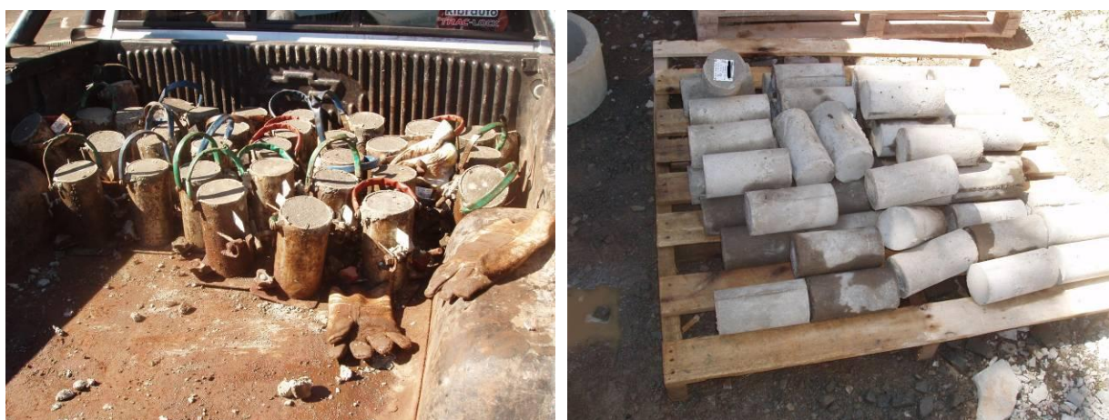
Fig. 3 – Transporte inadequado dos corpos de prova, sem uso de caixas de areia.
