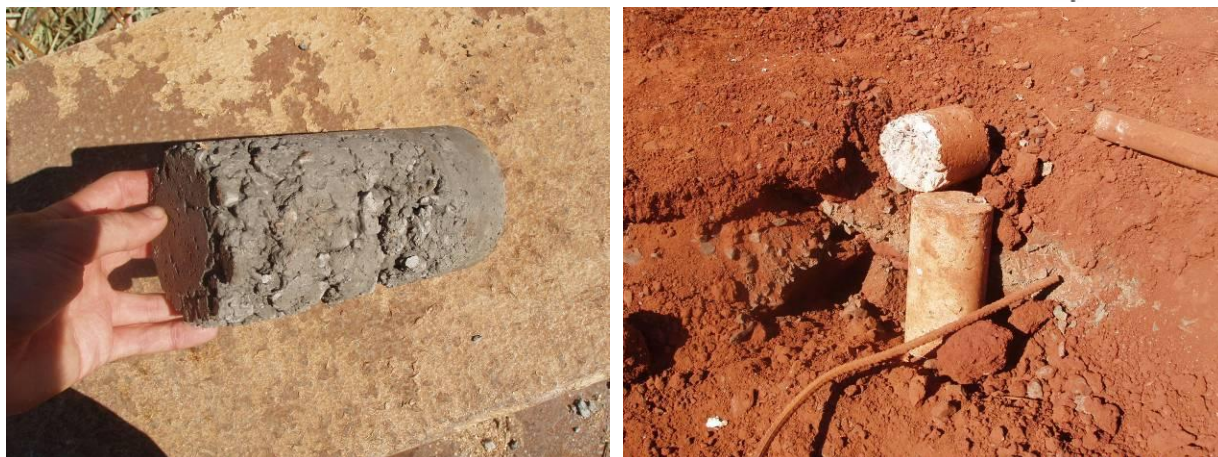
Fig. 2 – Corpos de prova com falhas de moldagem (esquerda) e abandonados na obra (direita).
